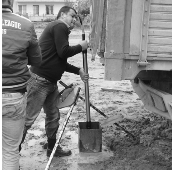
Şekil 4.4 Süspansiyon PS-hızı logu uygulamasında deney probunun kuyuya indirilmesi
