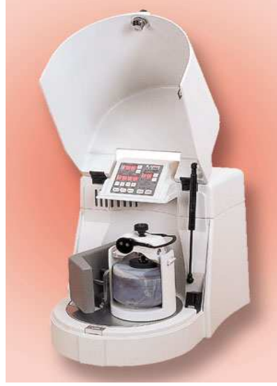
Şekil 3.1. Deneysel çalışmalarda kullanılan gezegensel değirmen
