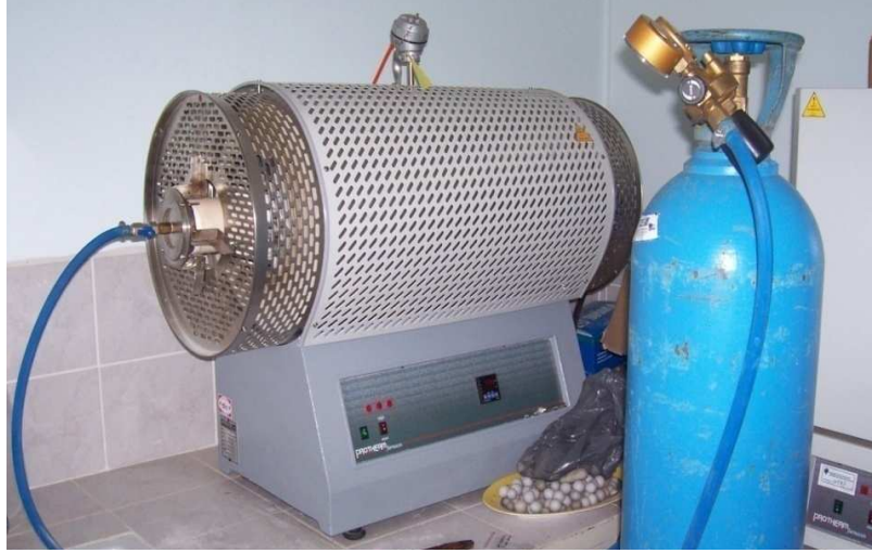
Şekil 3.2. Redüksiyon çalışmalarında kullanılan tüp fırın
