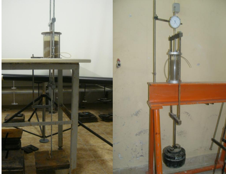
Şekil 3.8 Bulamaçtan Numune Hazırlanması-Konsolidasyon silindirleri (a) 100mm çap (b) 50mm çap
