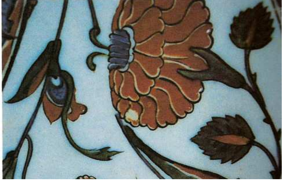
Resim 40 Mercan kırmızı renkte kopma (Fırınlama esnasında)
