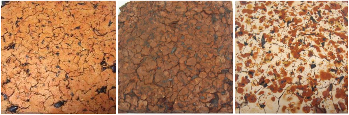
Şamotlu Çamur %66 Kırmızı Çamur %66 Akçini Çamur %66 Demir Talaşı Katkısı %34 Demir Talaşı Katkısı %34 Demir Talaşı Katkısı %34
