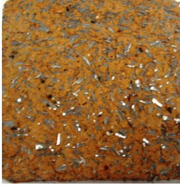
Şamotlu Çamur %66 Alüminyum Talaşı Katkısı %34
