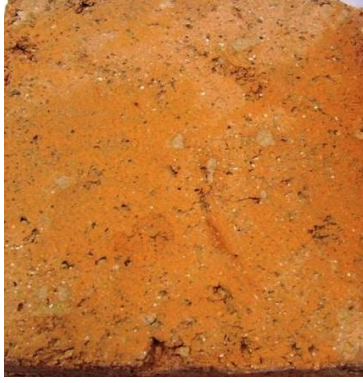
Şamotlu Çamur %66 Refrakter Katkısı %34
