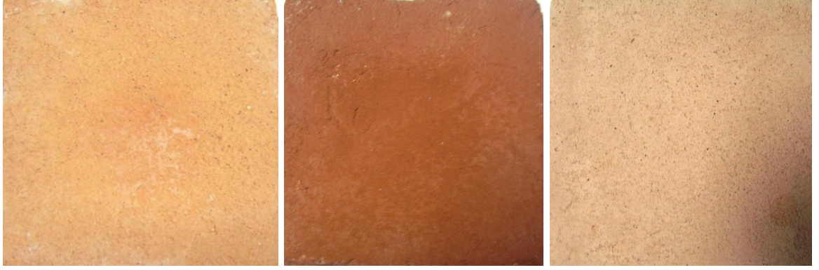
Şamotlu Çamur %90 Talaş Katkısı%10
