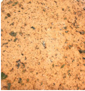
Şamotlu Çamur %50 Şişe Camı Katkısı %50
