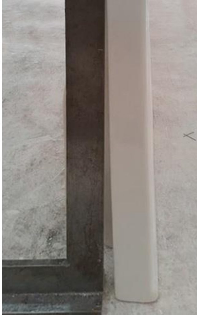
Fotoğraf 54: Uygulama ürününde gönye ile geriye eğilme kontrolü
