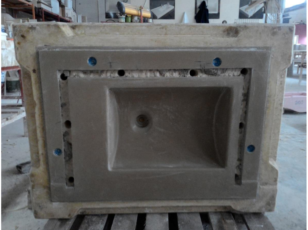
Fotoğraf 45: Tadilat aktarmak için hazırlanmış ana kalıp bloğu
