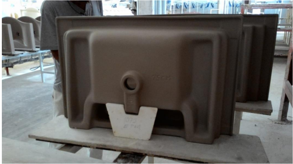
Fotoğraf 40: Çökmeyi önlemek için hazne arkasında kullanılan alçı destek
