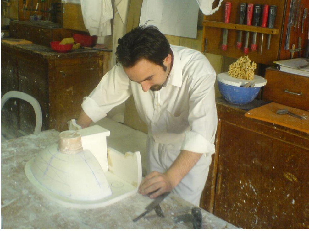
Fotoğraf 22: Lavabo modeli yapım çalışması, Toprak Seramik
