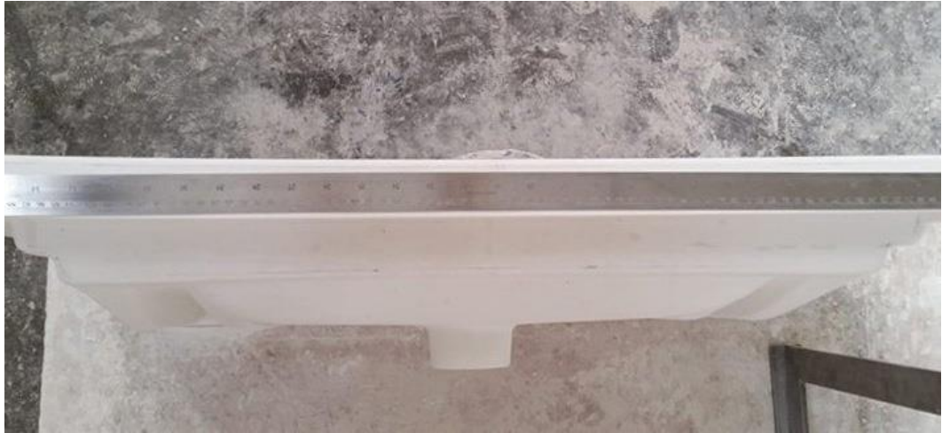
Fotoğraf 56: Uygulama ürünü ön bant yüzeyinin çelik cetvel ile kontrolü
