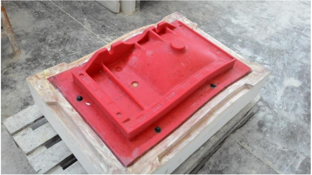
Fotoğraf 49: Teksir alçısı ve silikon malzemeden oluşan ana kalıp parçası
