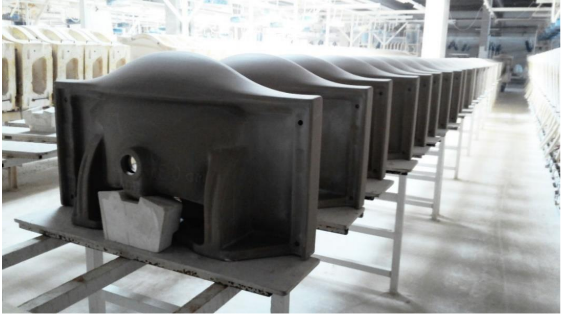
Fotoğraf 11: Batarya döküm sisteminde şekillendirilen konsollu lavabolar
