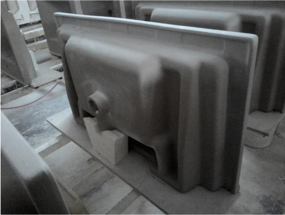
Fotoğraf 62: Seri üretimde alçı desteğin su taşıma kanalında kullanılması
