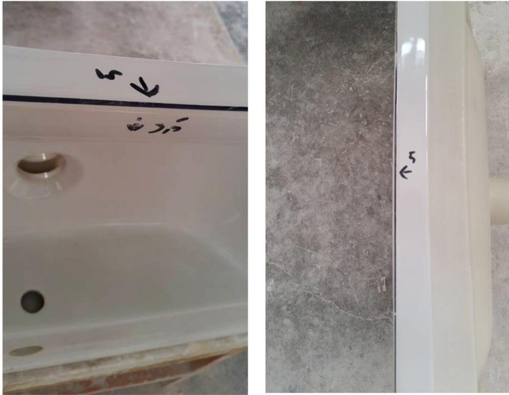
Fotoğraf 55: Uygulama ürünü olan dörtgen lavaboda çökme oranları
