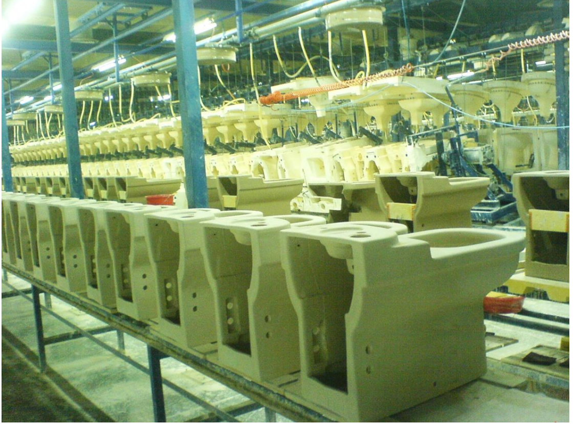
Fotoğraf 12: Mekanize döküm sisteminde şekillendirilen klozetler
