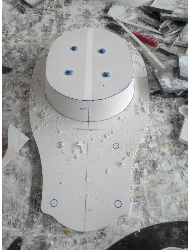
Fotoğraf 13: Alçı kullanılarak şekillendirilen klozet modeli
