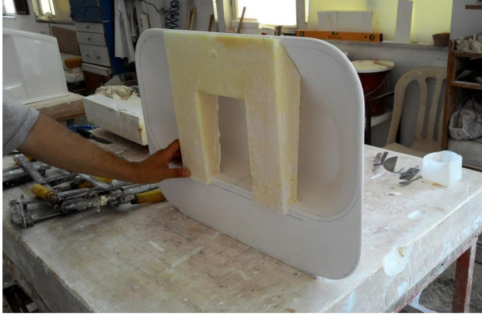
Fotoğraf 38: Lavabo modeli üzerinden poliüretan desteğin ayarlanması
