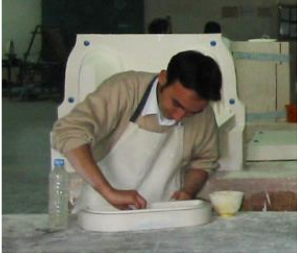
Fotoęraf 16: Modelci tarafından rezervuar kapaęı modeli yapımı
