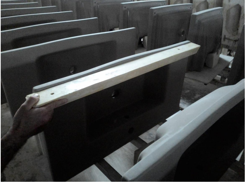
Fotoğraf 60: Seri üretimde poliüretan düzeltme mastarının uygulanması
