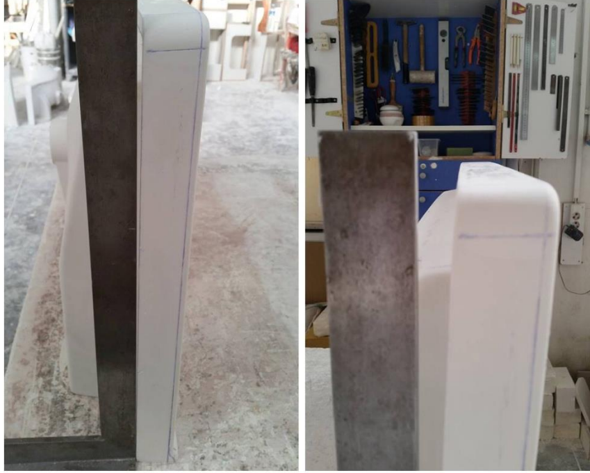
Fotoğraf 51: Uygulama ürünü modelinin çelik gönye ile kontrol edilmesi
