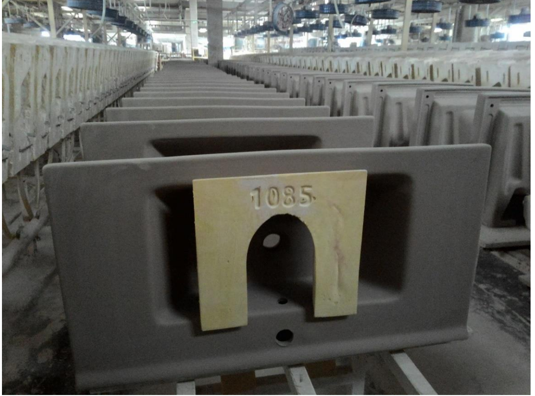
Fotoğraf 59: Seri üretimde hazne içerisinde poliüretan destek kullanılması
