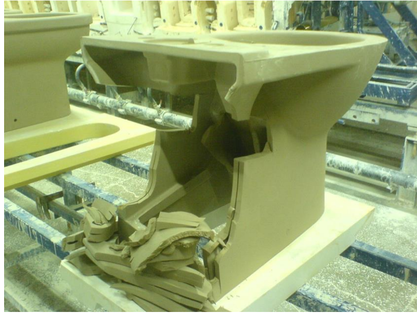
Fotoğraf 15: Yarı üründe et kalınlıklarının kontrol edilmesi
