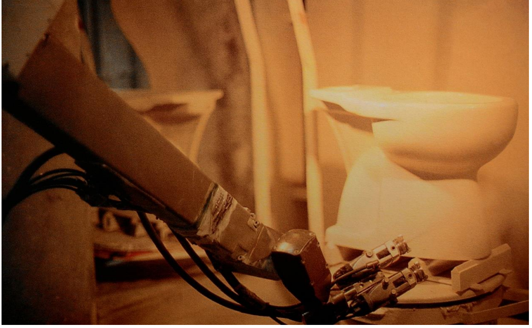
Fotoğraf 26: Sırlama işlemini gerçekleştirmek üzere programlanmış robot
