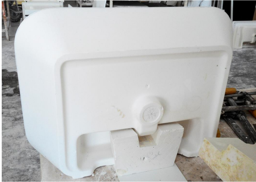
Fotoğraf 43: Lavabo modeli üzerinden pişme bomzesinin oluşturulması
