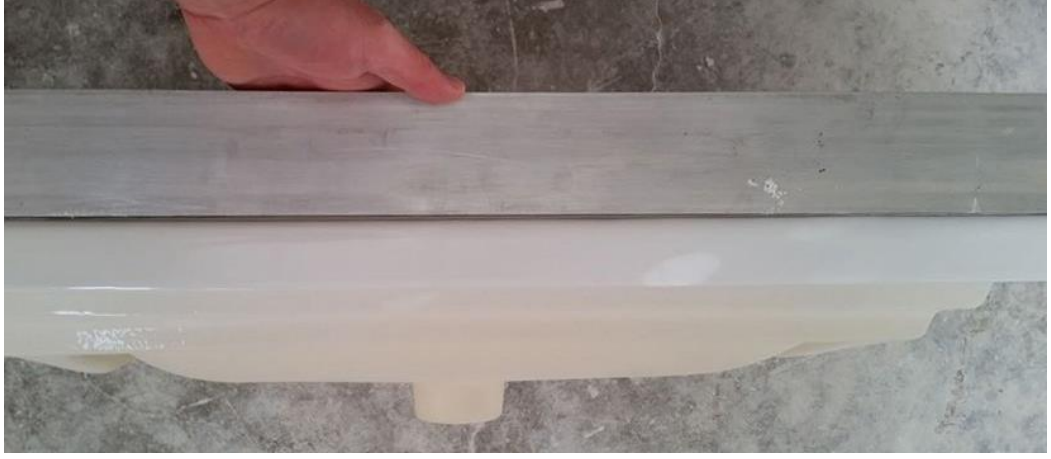
Fotoğraf 57: Uygulama ürünü üzerinde mastar ile deformasyon kontrolü
