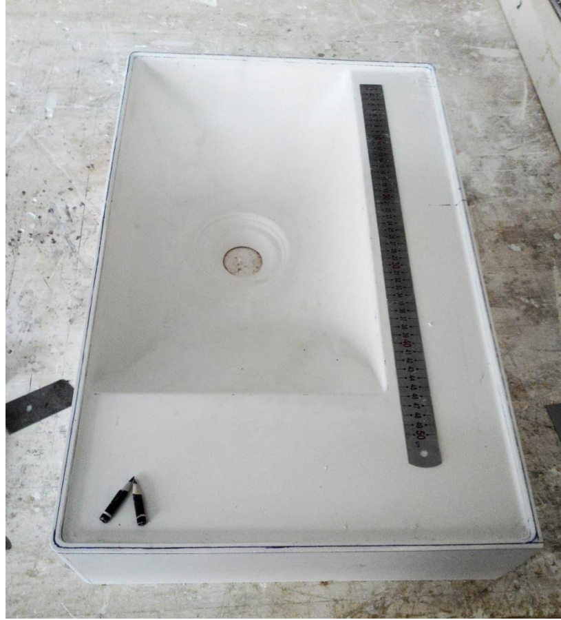
Fotoğraf 19: Alçıdan yapılmakta olan bir dörtgen lavabo maketi
