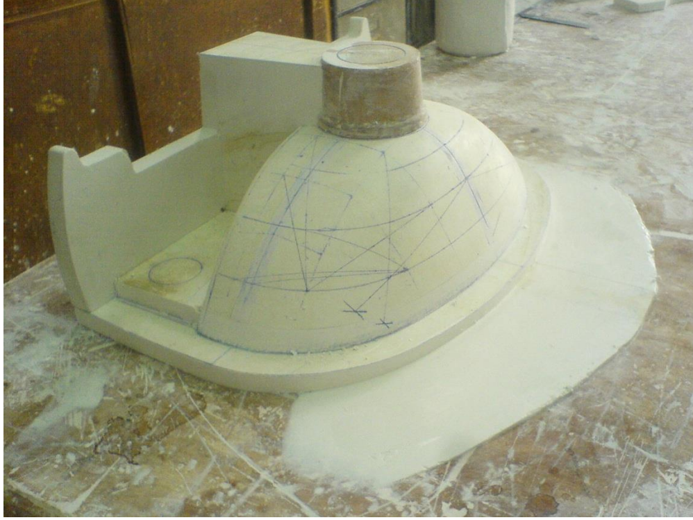
Fotoğraf 23: Deformasyonu önlemek için modele alçı rampa uygulaması
