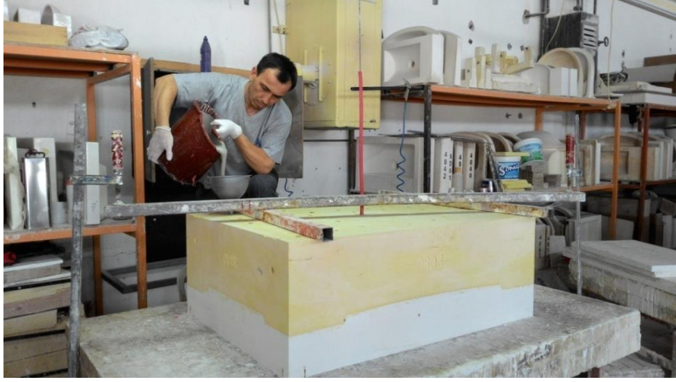
Fotoğraf 48: Silikon malzemenin ana kalıp içerisine dökülmesi
