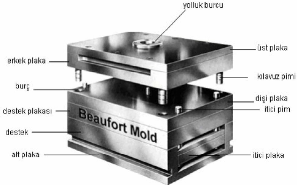
Şekil 9. Bir Plastik Enjeksiyon Kalıbının Şematik Gösterimi (Kaynak: MEGEP Plastik Teknolojisi, 2006: 30)
