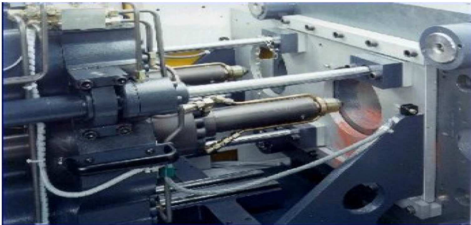
Şekil 8. Enjeksiyon ünitesi (Kaynak: MEGEP Plastik Teknolojisi, 2006:8)
