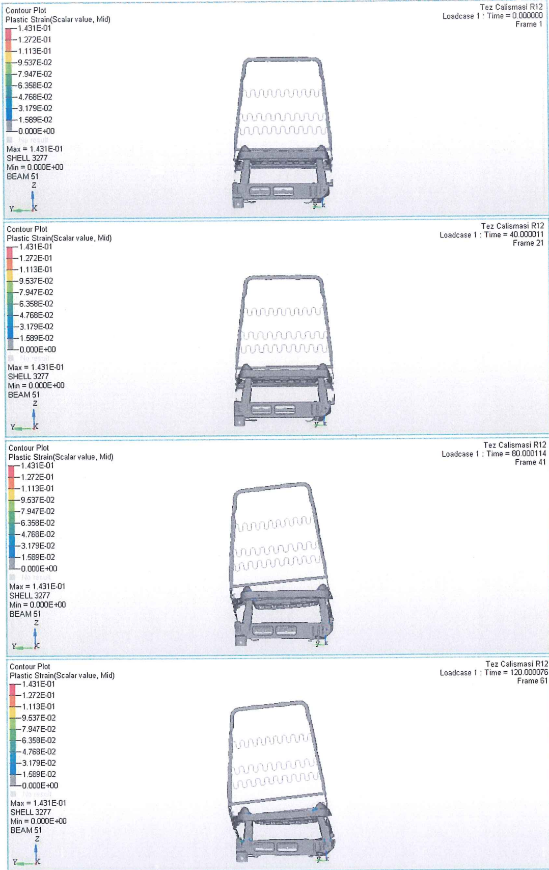
Şekil 6.22. R12' ye göre farklı zamanlarda koltuk üzerinde plastik zorlanma-önden görünüş
