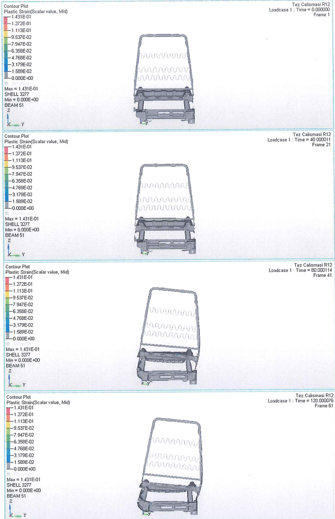
Şekil 6.23. R12' ye göre farklı zamanlarda koltuk üzerinde plastik zorlanma-arkadan görünüş
