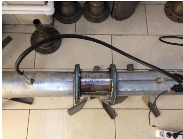
Şekil 4.5. Fark basınç sensörünün bağlantısı
