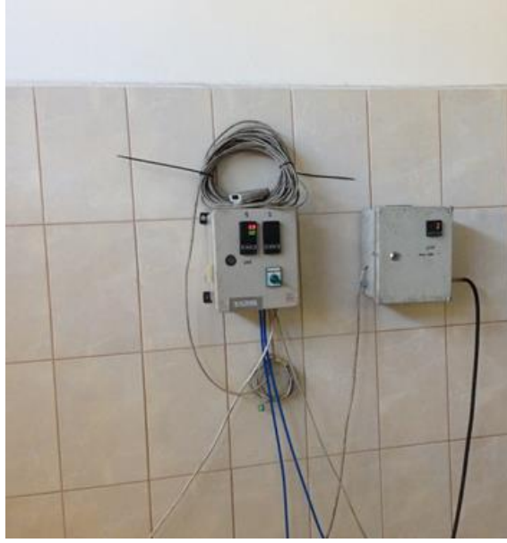
Şekil 4.6. Basınç farkı ve venturimetre değerlerini okuma ekranları
