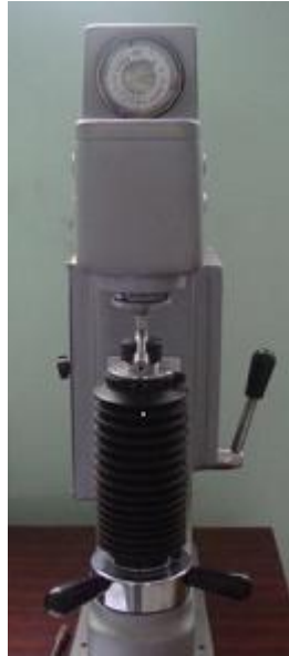
Şekil 3.3. Sertlik ölçme test cihazı fotoğraf görüntüsü.
