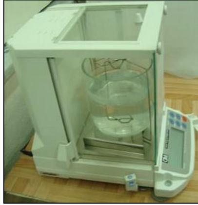
Şekil 3.2 Yoğunluk ölçüm düzeneği.
