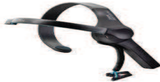
Şekil 2.3. NeuroSky MindWave Mobile cihazı [23]
