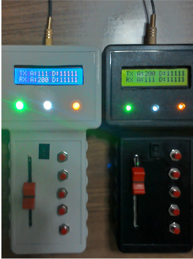
Şekil 4.13. Donanımsal testler için oluşturulan master ve slave el terminalleri
