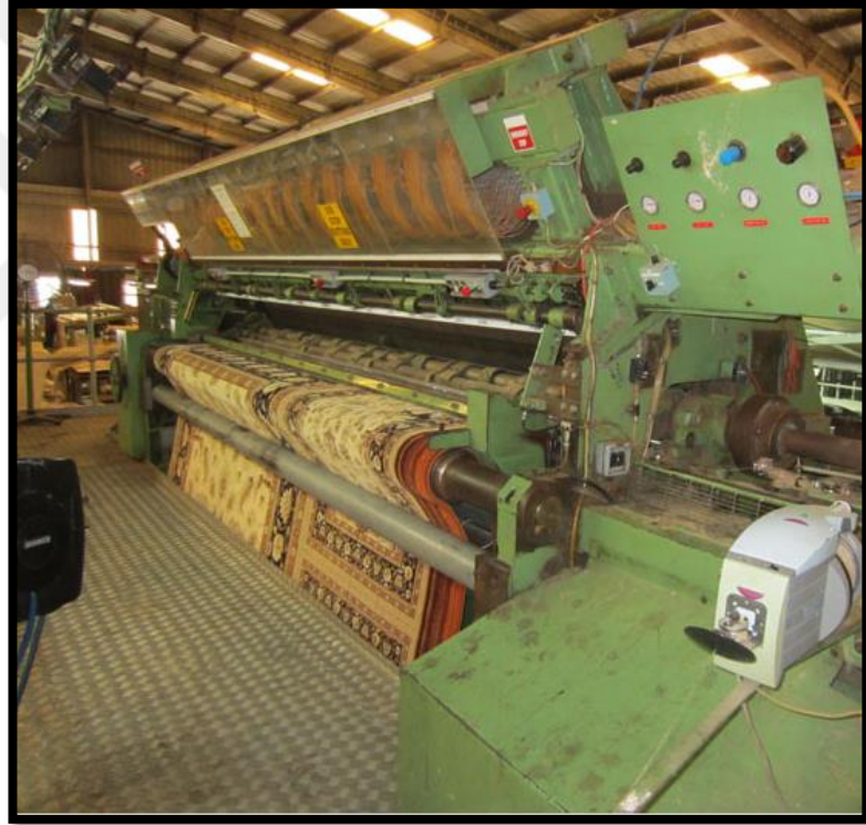
Fotoğraf 15 Tıgılı (Gripper) Dokuma Tezgahı
