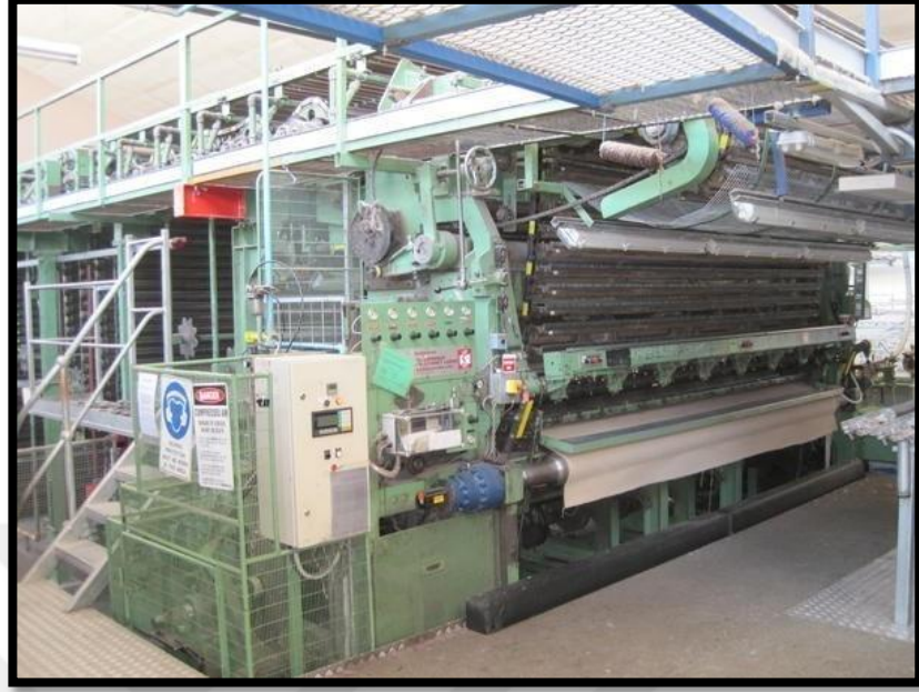
Fotoğraf 16 Makaralı Tıǒh ( Spool- Gripper) Tezgah
