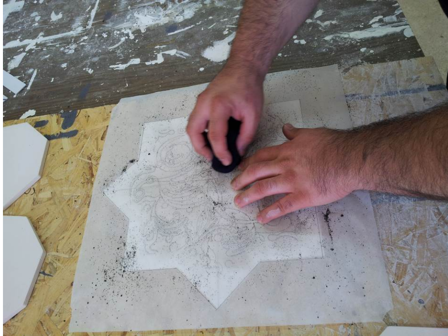
Resim 221: Çini Karolara Desenin Kömür Tozu ile Geçirilmesi
