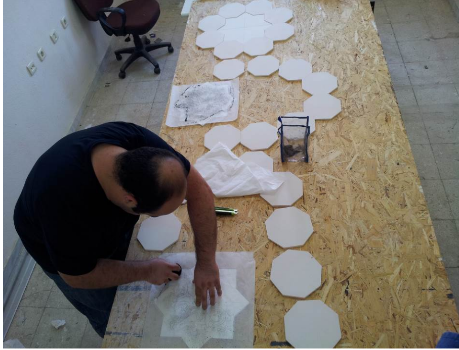
Resim 221: Çini Karolara Desenin Kömür Tozu ile Geçirilmesi
