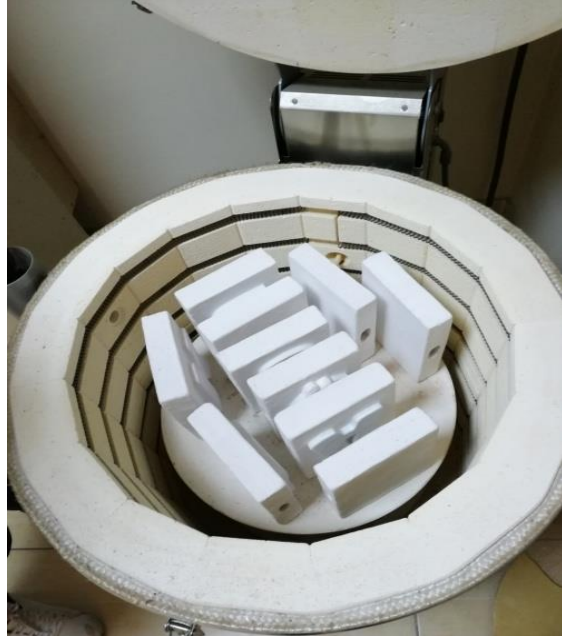
Resim 35: Modüllerin Sır Pişirim İçin Fırına Yerleştirilmesi.
