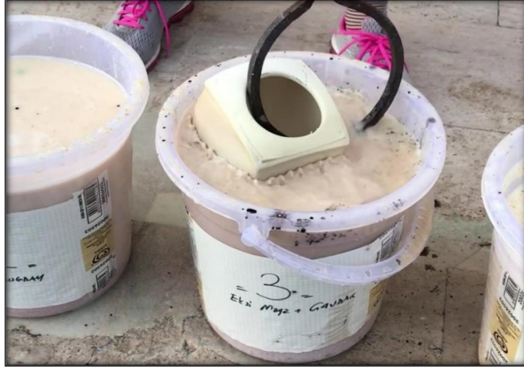
Görsel 43: Fırından Çıkarılan Ürünün Solüsyona Daldırılma İşlemi ve Kaynama Etkisi
