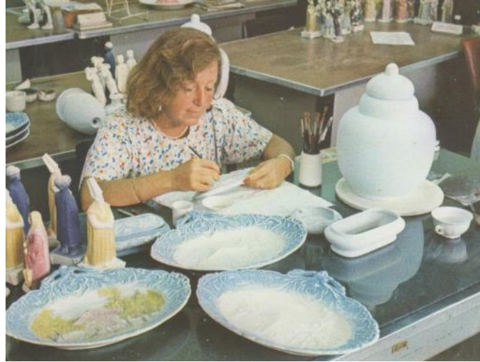
Görsel 85: Vejvut ( Klasik Yıldız Tekniği) Çalışması, Kuru Haldeki Yarı Mamul Üzerine Rölyef Uygulamasını Çalışırken.
