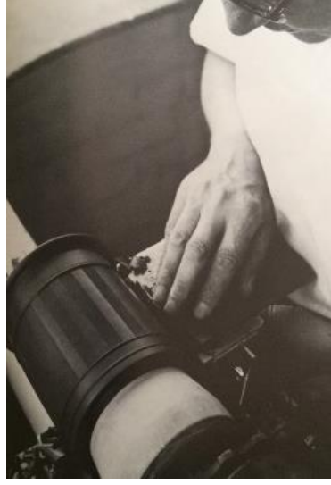
Görsel 6: Wedgwood Fabrikalarında Uygulanan Yatay Eksenli Torna Dekorü.
