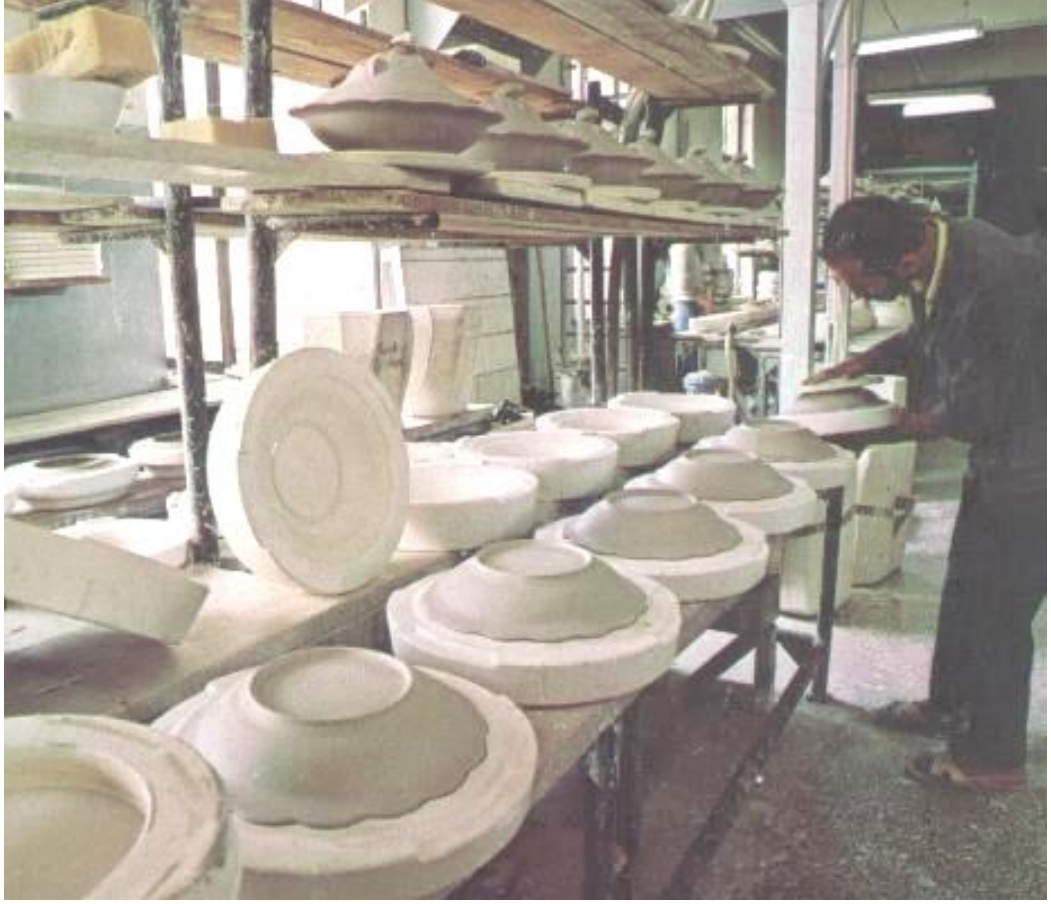
Görsel 91: Şekillendirme Atölyesinde Şekerlik Alt Gövdesinin Döküm İşlemleri, Yıldız Çini ve Porselen Fabrikası.
