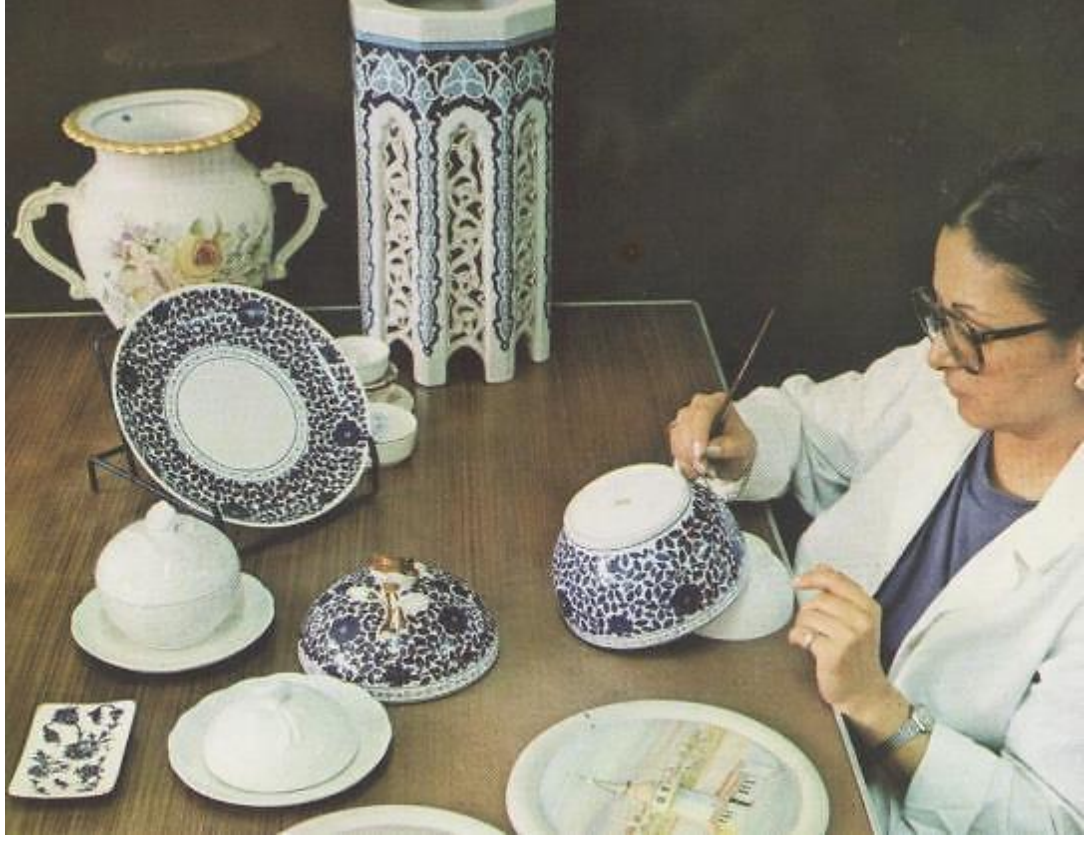
Görsel 61: El Dekorü Atölyesinde Karpuz Şekerlik Üzerine Sırüstü Teknikle Uygulanan ve Pişirimi Yapılan Klasik Kuşlu Desenin Altın Kontörlerinin Uygulanışı.
