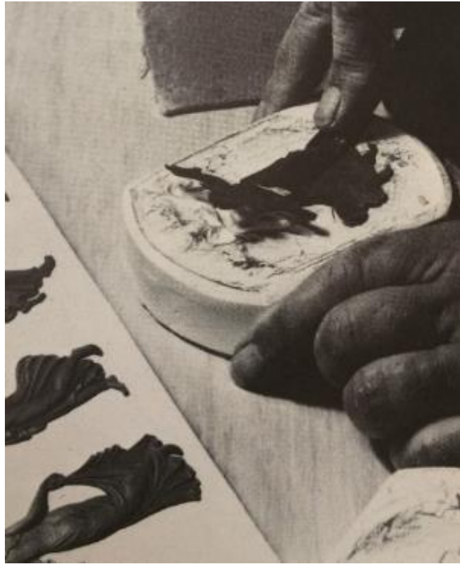
Görsel 38: Parça Ekleme Dekorü İçin Basılan Çamurun Kalıptan Çıkarılması.
