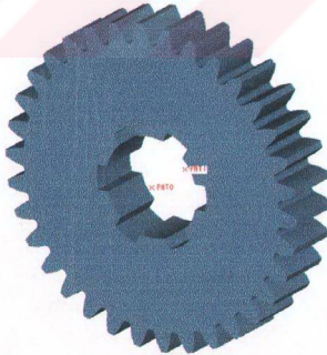
Şekil 3.20: Hazırlanmış bir dişli ve üzerindeki referans noktaları
