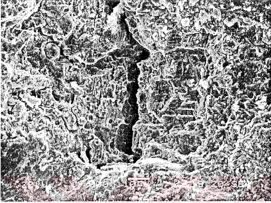
Şekil 5.18. Kaynaklı boji numunesinin 500 MPa'da yapılan yorulma deneyinde yüzeyde oluşan kırık görüntüsü.
