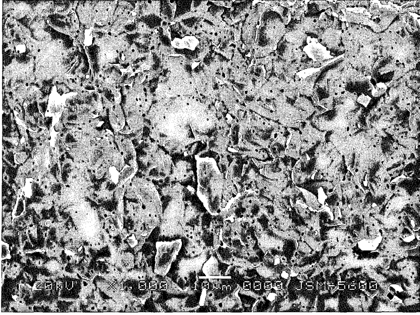
Şekil 5.19. CS 1 Z 1 kodlu numunenin SEM görüntüsü (CS 1 Z 1 : ZnO - %97 mol CuO - % 3 mol 1000 °C de 1 saat sinterlenmiş )
