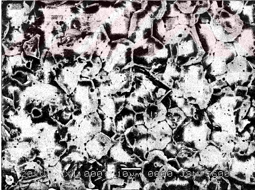
Şekil 5.26. BS_4Z_1 kodlu numunenin SEM görüntüsü ( BS_4Z_1 : ZnO - %98 mol CuO - % 2 mol 1300 °C de 1 saat sinterlenmiş )
