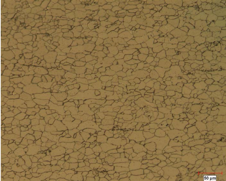
Şekil 5.2 galvaniz kaplı 1312 kalite malzemenin mikroyapısı (200x, ASTM No:9, 15,0-15,9µm, 60/60 g/m 2 GI, t=1,18 mm)
