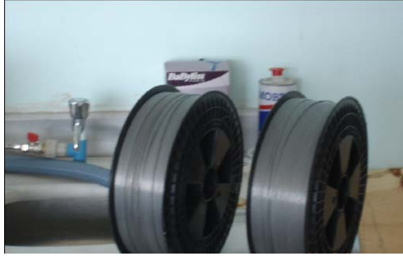
Şekil 7.2. Yapısı incelenmiş olan 85/15 Zn/Al alaşımı ark püskürtme kaplama teli
