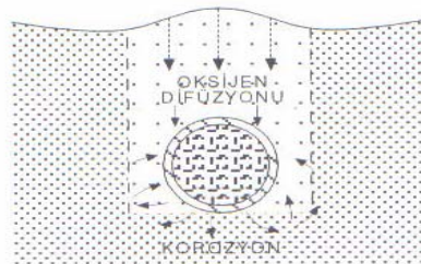
Şekil 2.8. Farklı havalanma nedeniyle borun tabanında oluşan korozyon[2]
