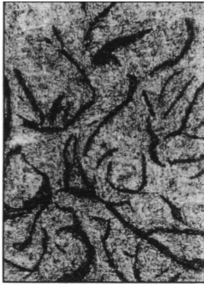
Şekil 2.3. Gri dökme demirin (fleyk grafitli) a) optik ve b) tarayıcı elektron mikroskobu (SEM) mikroyapısı. Perlitik matris içinde A-tipi grafit yapısı. %4 picral ile dağlama. Elektron mikroskobunda gözlenen yapı %4 HCl çözeltisinde 1 Gün dağlamadan sonra elde edilmiştir (%C: 3,31, %Si: 2,48, %Mn: 0,54 %, S: 0,037, %P: 0,019) [1]
