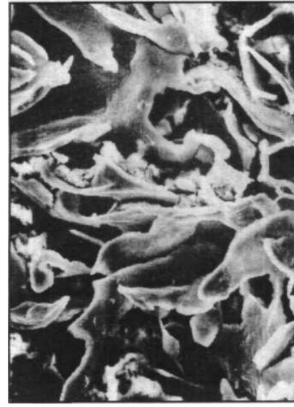
Şekil 2.3. Gri dökme demirin (fleyk grafitli) a) optik ve b) tarayıcı elektron mikroskobu (SEM) mikroyapısı. Perlitik matris içinde A-tipi grafit yapısı. %4 picral ile dağlama. Elektron mikroskobunda gözlenen yapı %4 HCl çözeltisinde 1 Gün dağlamadan sonra elde edilmiştir (%C: 3,31, %Si: 2,48, %Mn: 0,54 %, S: 0,037, %P: 0,019) [1]
