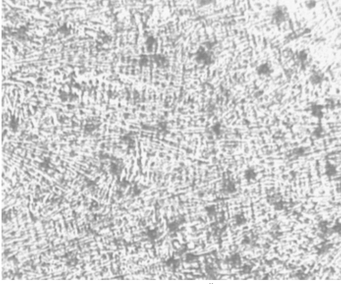
Şekil 6.9. 1,5mm kalınlığındaki HA2 nolu döküm numunesinin mikroyapısı
