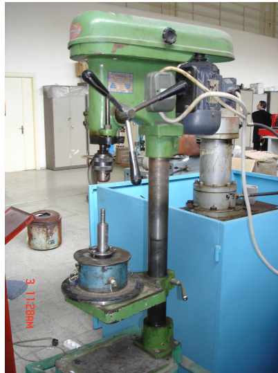
Şekil 3.1. Deneysel çalışmalarda kullanılan atritör
