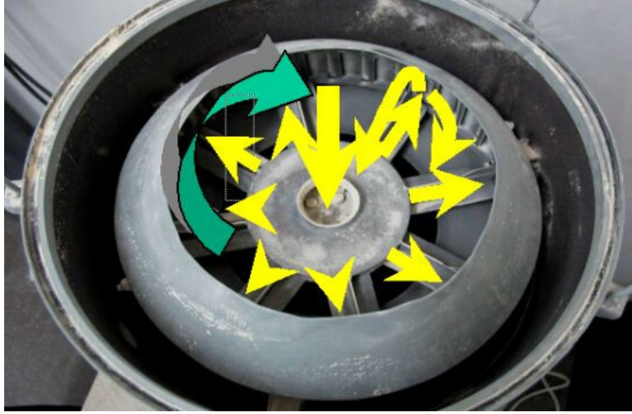
Şekil 2.6. Aktive edilen malzemenin hareketini gösteren mekanik aktivator [13]
