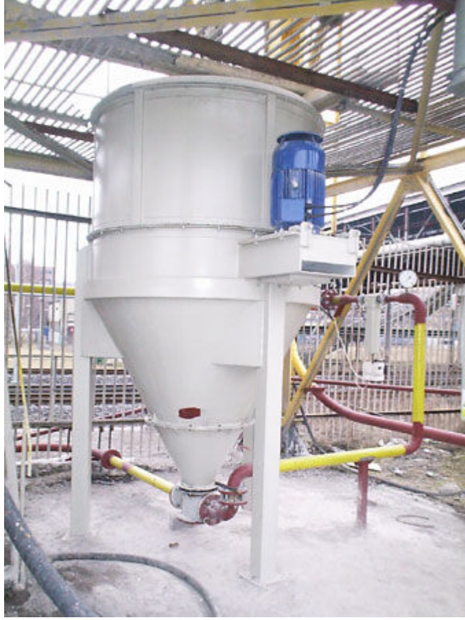
Şekil 2.12. 5 ton/saat kapasiteli bir mekanik aktivatörün görünümü [13]
