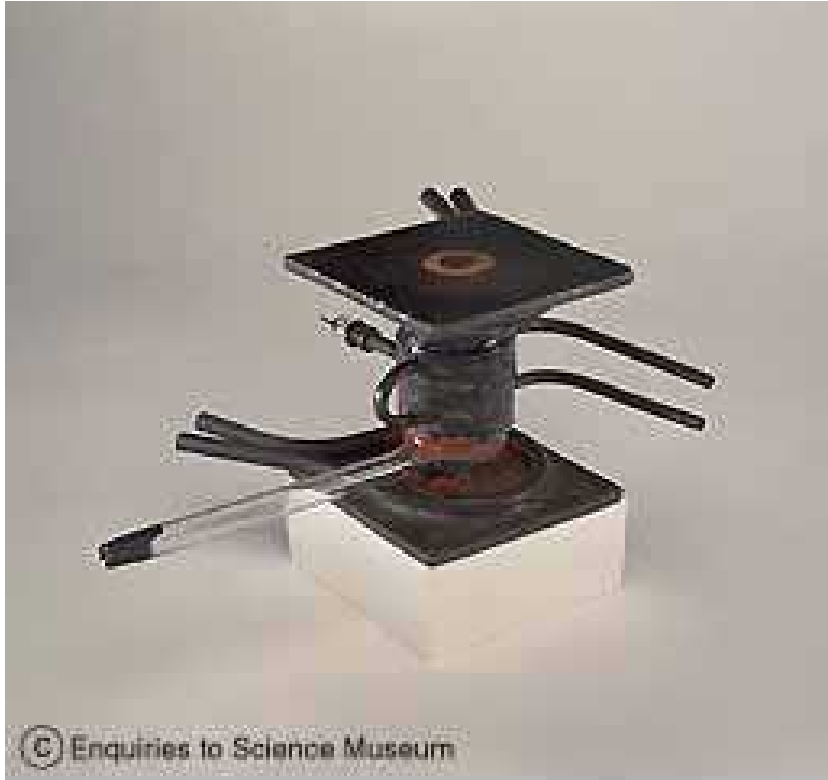
Şekil 5.4. İlk İngiliz Magnetronu
