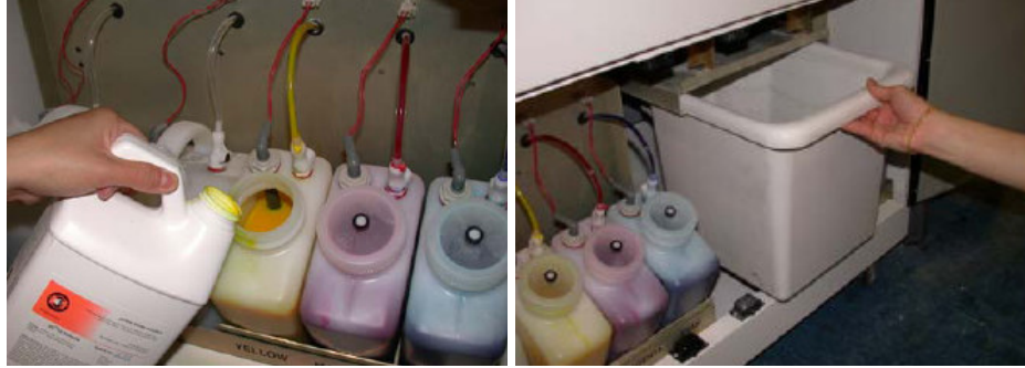
Şekil 4.18. Yapıştırıcı şişelerine yapıştırıcı konulması ve atık toz kovası
