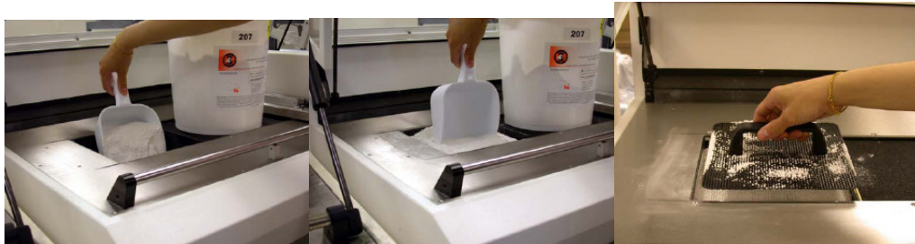
Şekil 4.15. Besleme bölümüne inşa tozunun yüklenmesi ve zeminin düzleştirilmesi
