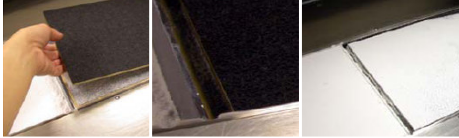
Şekil 4.16: İnşa kutusuna taşıma tablası konulması ve tozla kaplanmış hali.
