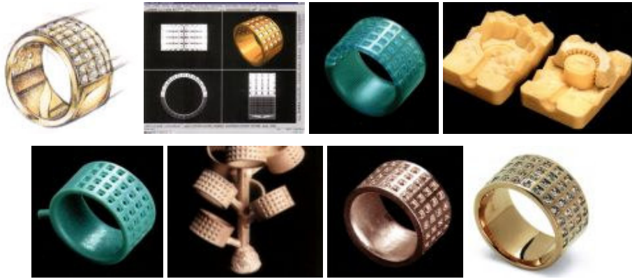
Şekil 2.16. Kuyumculukta yapılan üretimi önemli derecede hızlandıran sistemin aşamaları
