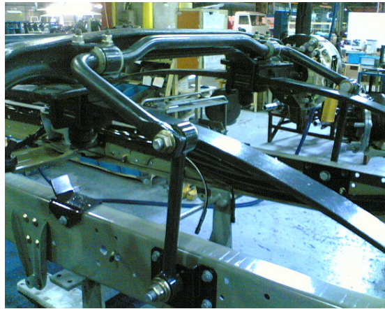
Şekil 3.4 Ön denge çubuğu montaj şekli
