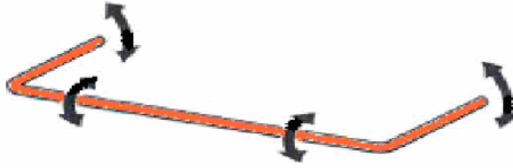
Şekil 1.2 Denge çubuğunun çalışması
