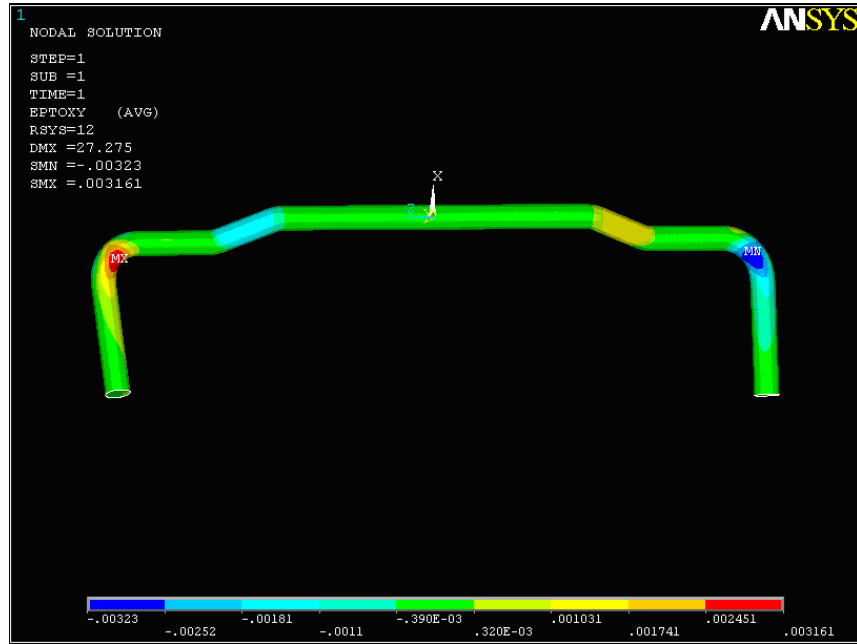
Şekil 4.18 XY yönünde oluşan kesme zorlanması( XY Shear Strain)
