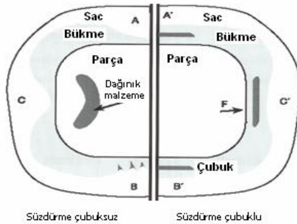
Şekil 1.7 Süzdürme çubuğu ve kanalı kullanılmadan sacda oluşan potansiyel koşullar [10]
