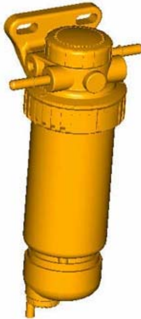
Şekil 6.1 Standart bir kâğıt elemanlı yakıt filtresi CAD modeli
