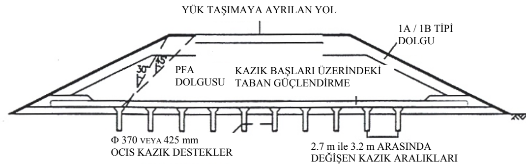
Şekil 4.13. Kazık destekli dolgu kesiti
