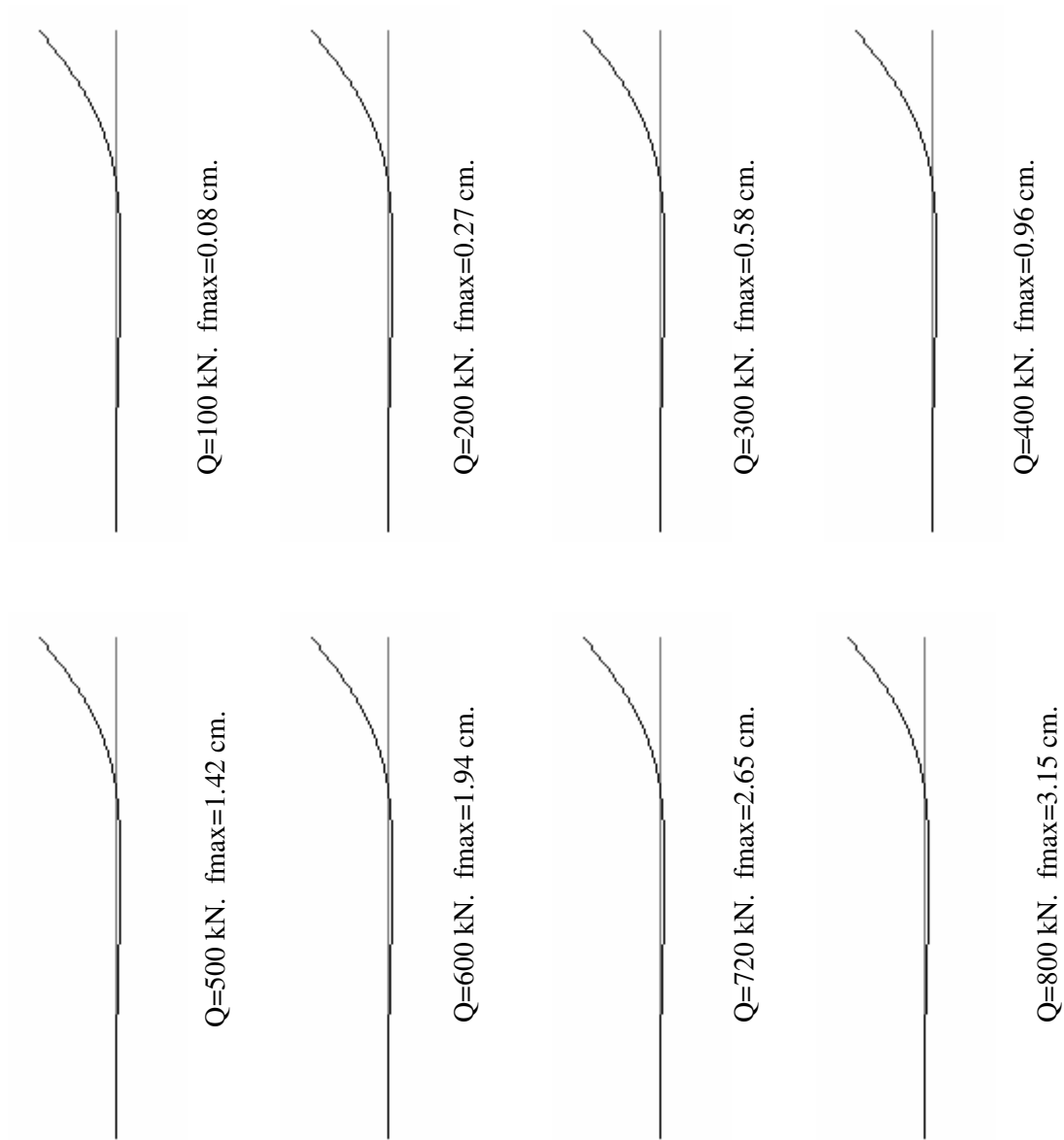
Şekil 4.15 Allpile kazık modelinde, yüke bağlı kazık başındaki deplasmanlar
