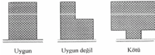
Şekil 2.10. Düşeyde uygun olan ve olmayan yığma yapı geometrileri (Tomazević, 1999).
