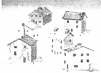
Şekil 2.14. Yığma yapılarda yapısal orta hasar
