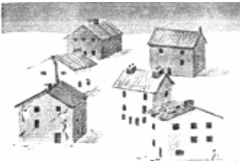
Şekil 2.13. Yıđma yapılarda yapısal hafif hasar
