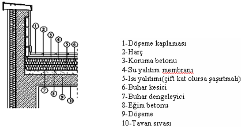
Şekil 4.8 Üzerinde gezilen teras çatılarda ısı yalıtım uygulaması[26]
