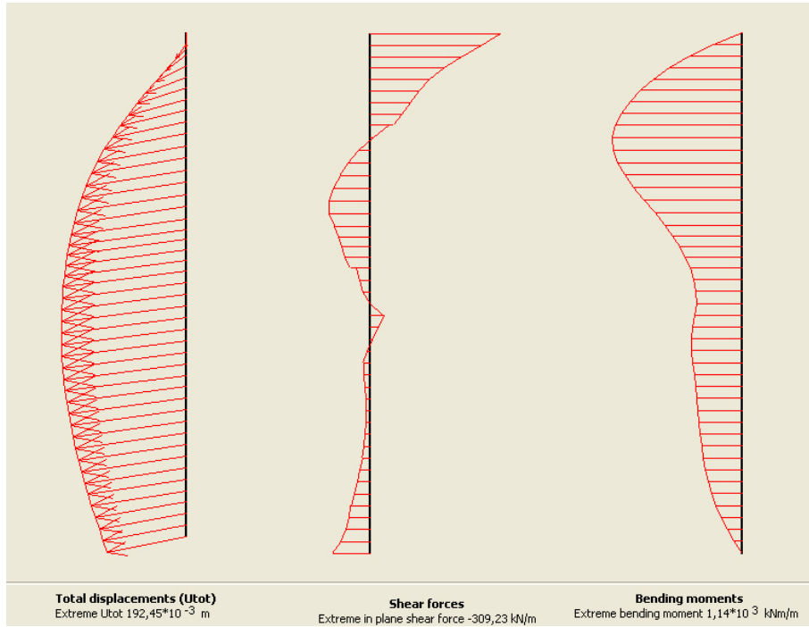
Şekil 6.101 Adım 3’de kazık 3 için deformasyon durumu
