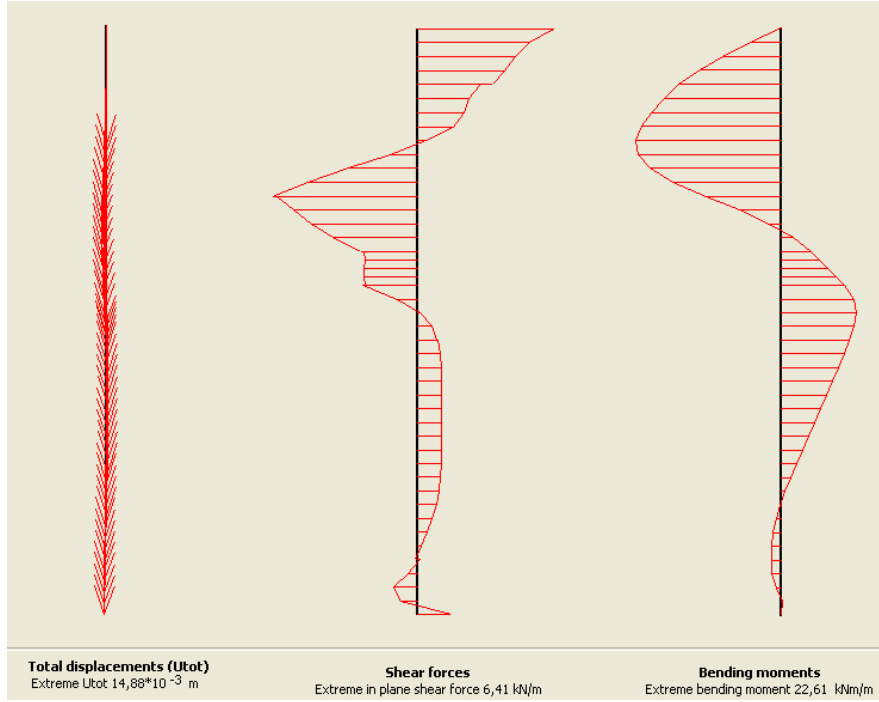
Şekil 6.97 Adım 2'de kazık 4 için deformasyon durumu
