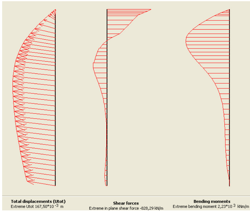
Şekil 6.99 Adım 3'de kazık 1 için deformasyon durumu
