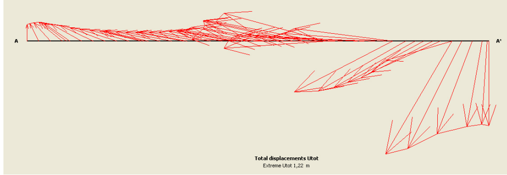
Şekil 6.39 deprem etkisi altındaki şevde a-a kesiti
