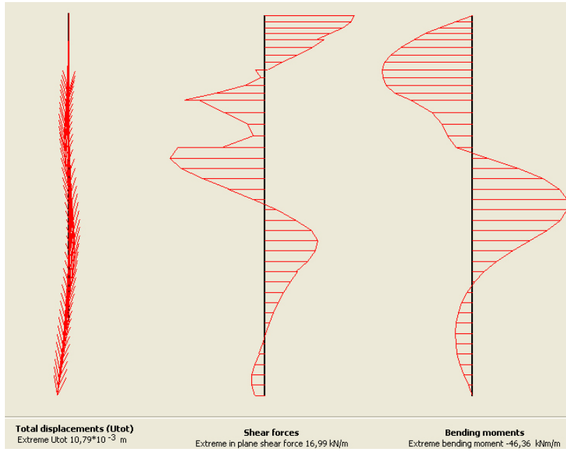
Şekil 6.95 Adım 2’de kazık 2 için deformasyon durumu
