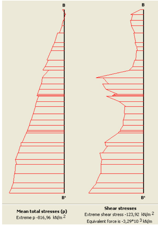
Şekil 6.41 Adım 3'de şevde oluşan gerilme ve kesme diyagramları
