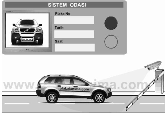
Şekil 4.4. Plaka Tanıma Sistemi İkinci Aşaması
