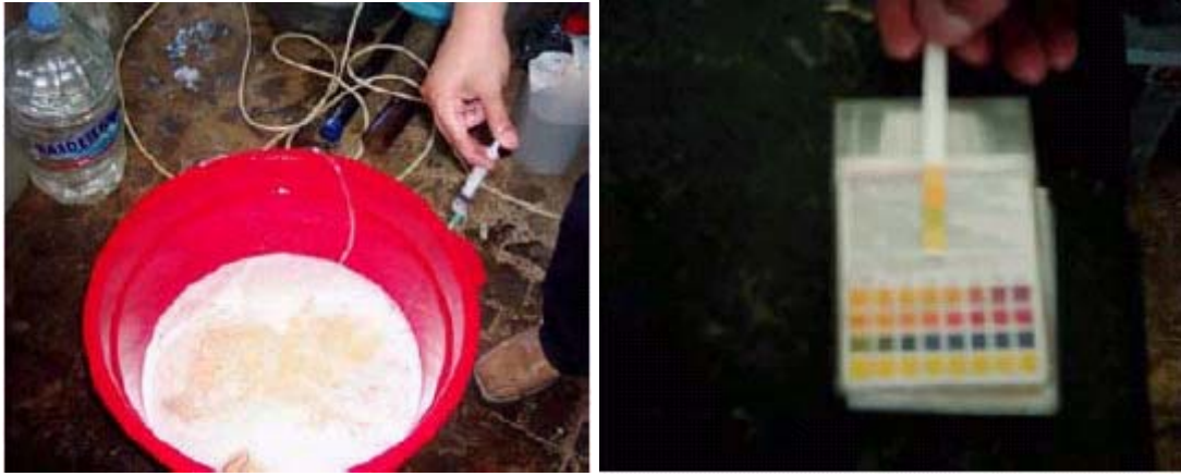
Şekil 4.4. Enjektör vasıtasıyla asit püskürtülerek pH seviyesinin ayarlanması
