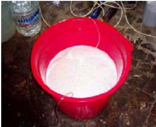
Şekil 4.3. Yıkama işlemi başlangıcında saf su ile pamuk yağı metil ester karışımının durumu
