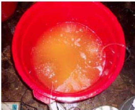
Şekil 4.5. pH seviyesi ayarlandıktan sonra (pH = 7) yıkama işlemi
