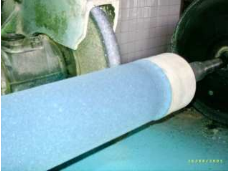
Şekil 2.8. Kaplama sarılan silindirin taşlama işlemi
