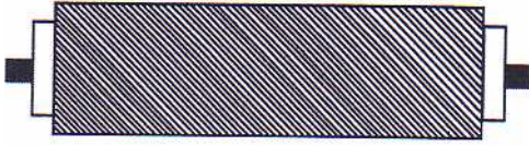
Şekil 3.25. F- Yivli (gravürlü) kalandır silindirinin büyütülmüş görünüşü.[7]
