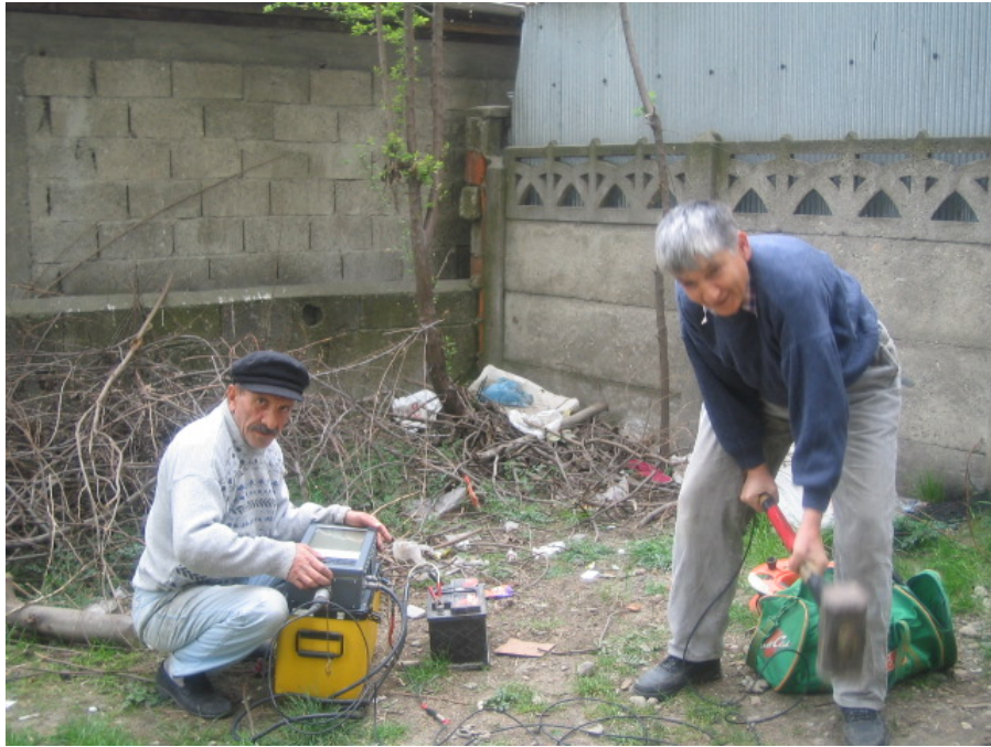
Resim 1. Geometrics Smart Seis Dijital Sismograf ve ölçüm araç gereçleri.
