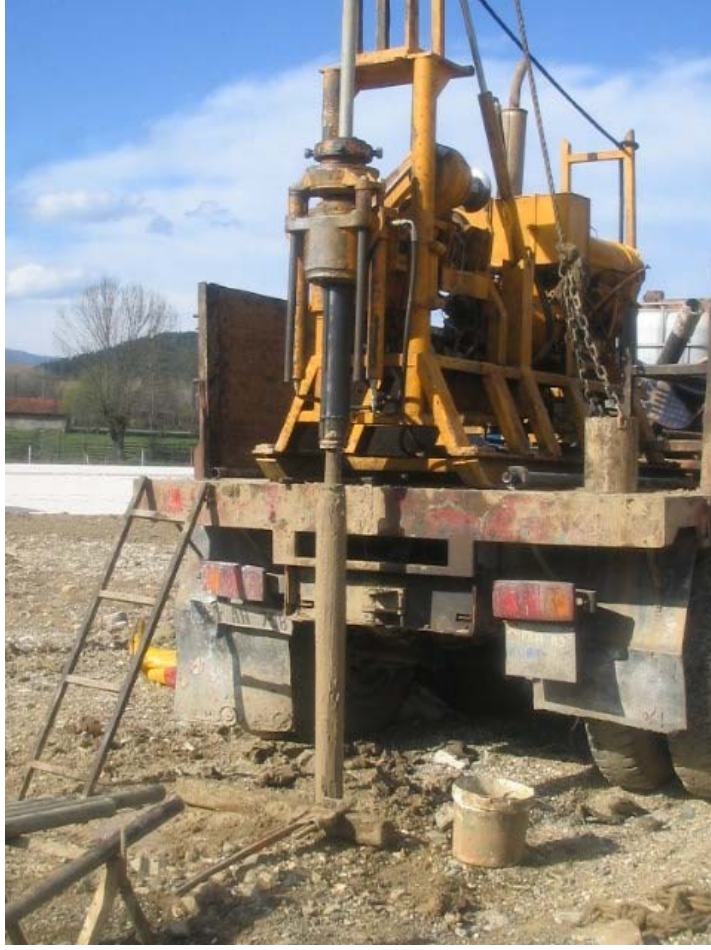
Resim 3: Düzce ilinde sondaj çalışmalarında kullanılan sondaj makinası
