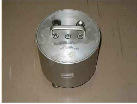
Şekil 3.1. Mark L4-3D, 3 Bileşen, Kısa Periyot kayıtçı
