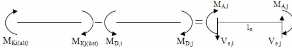
Şekil 3.6. K101 kirişinin +X deprem yükü ile uyumlu moment ve kapasiteleri
