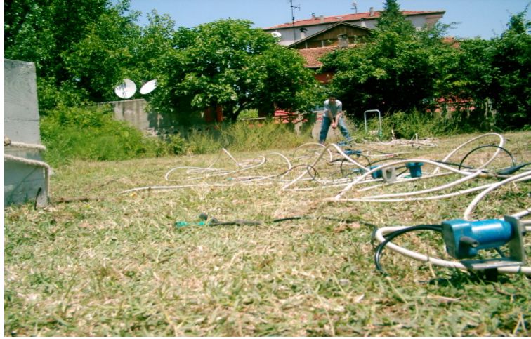
Şekil 5.10. Sismik kırılma deneyi jeofon uygulaması
