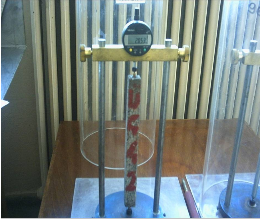
Şekil 4.5. Dijital komparatör ile örneklerin boy ölçümü
