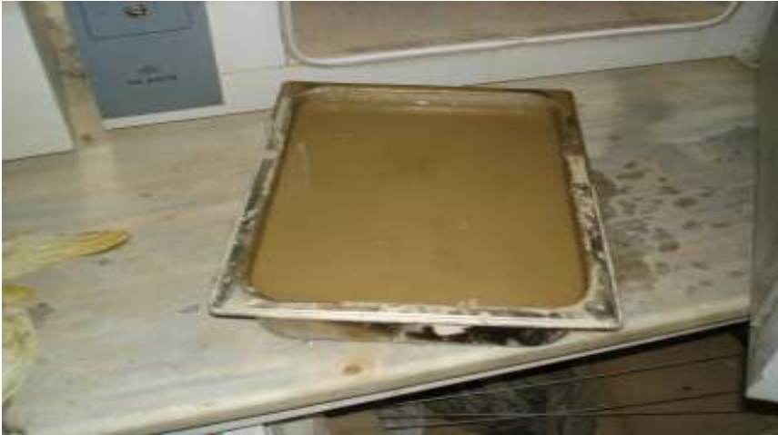
Şekil 5.7. CH Numunesinin Elendikten Sonra Etüve Atılması
