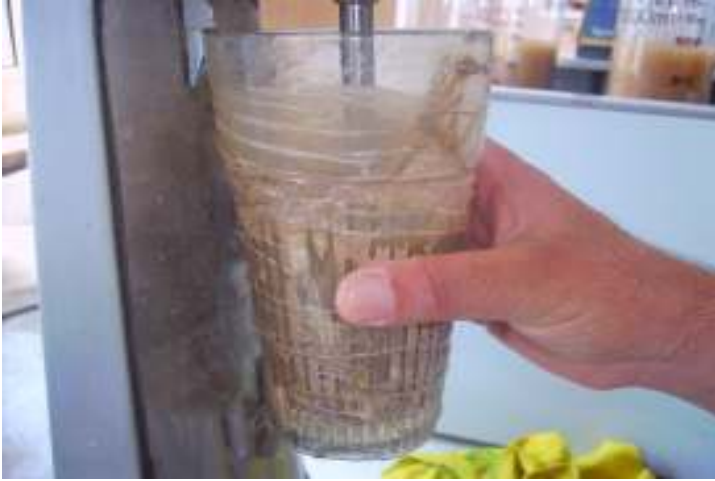
Şekil 5.12. Mikser Kullanılarak Hidrometrede Kullanılacak Numunenin Dağılması
