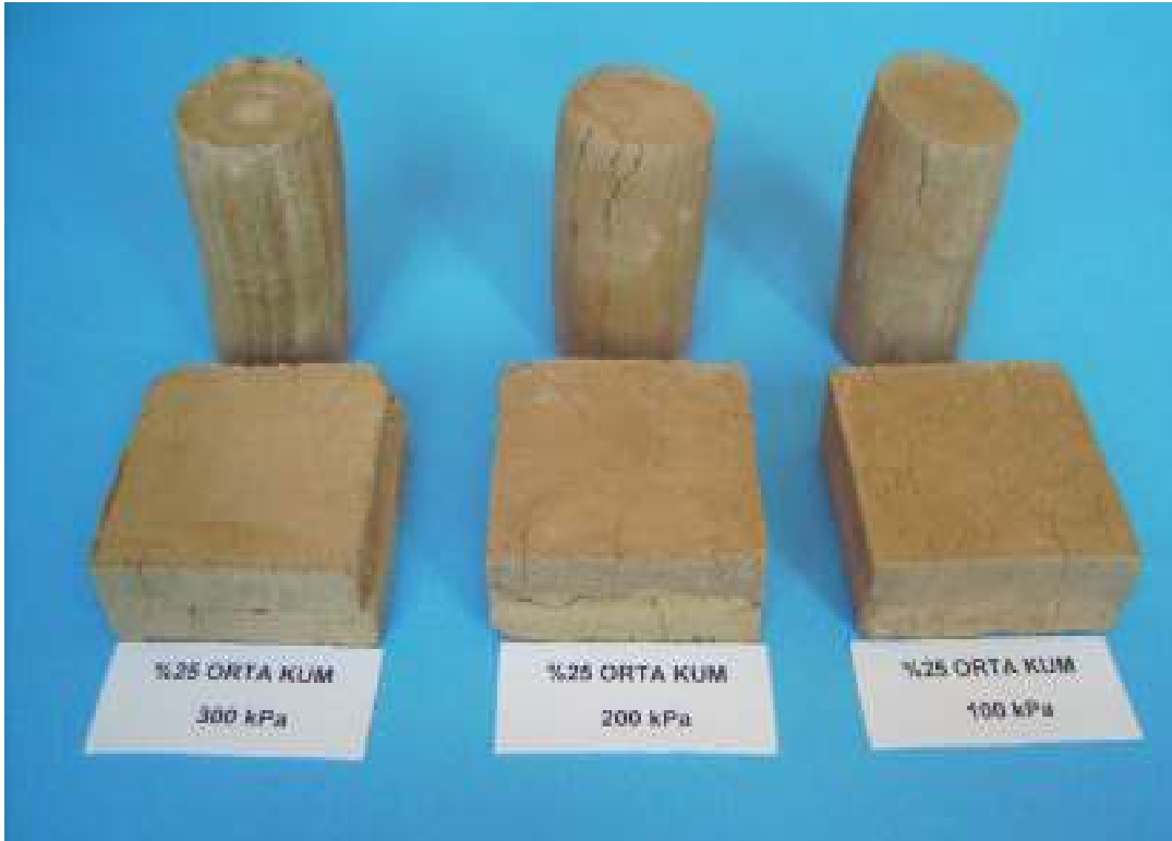
Şekil 5. 119. %25 Orta Kum İçeren CH Numunesinin 100kPa, 200kPa, 300 kPa Hücre Basıncı ve Normal Gerilme İle Kesildikten Sonraki Numunelerin Görünümü
