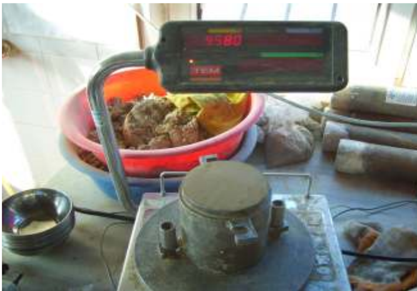
Şekil 5.22. Sıkıştırılmış Numunenin Kompaksiyon Kalıbı İle Tartılması
