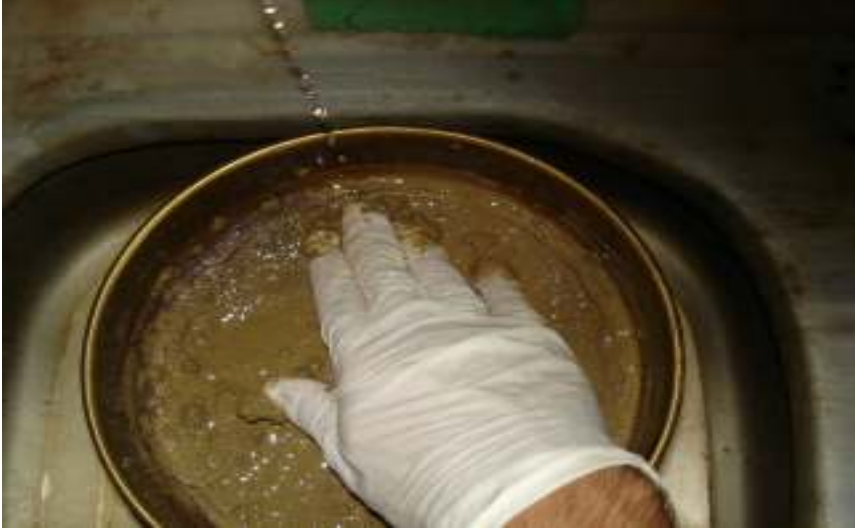
Şekil 5.6. CH Numunesinin Yıkamalı Yöntemle 200 Nolu Elekten Elenmesi
