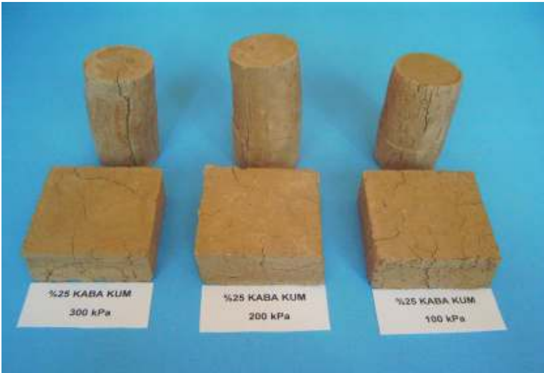
Şekil 5. 120. %25 Kaba Kum İçeren CH Numunesinin 100kPa, 200kPa, 300 kPa Hücre Basıncı ve Normal Gerilme İle Kesildikten Sonraki Numunelerin Görünümü
