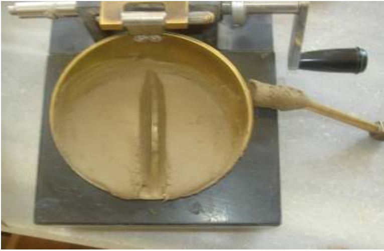
Şekil 5.2. Likit Limit Deneyinin Casagrande Cihazında Yapılması
