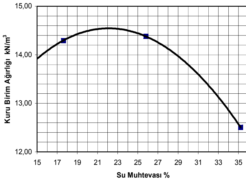
Şekil 5.24. %10 Orta Kum İçeren CH Numunesi İçin Kompaksiyon Eğrisi
