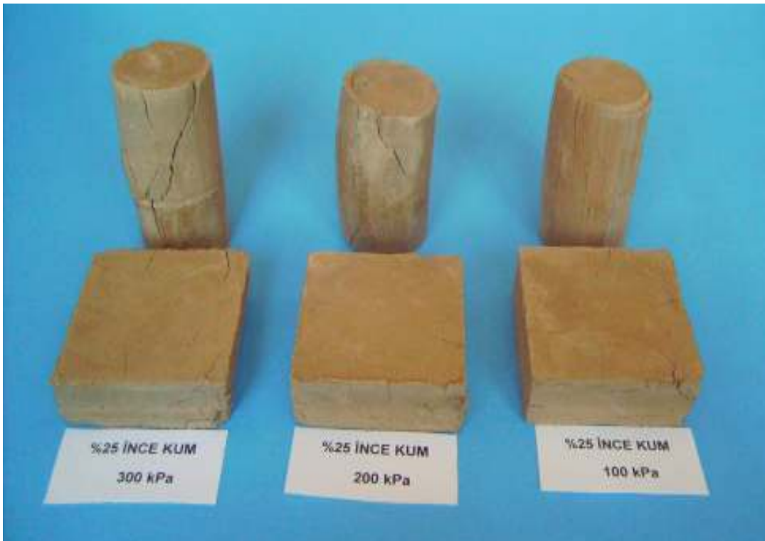
Şekil 5. 118. %25 İnce Kum İçeren CH Numunesinin 100kPa, 200kPa, 300 kPa Hücre Basıncı ve Normal Gerilme İle Kesildikten Sonraki Numunelerin Görünümü
