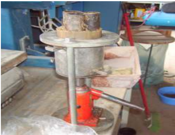
Şekil 5.37. Numunenin Kriko Yardımıyla Kompaksiyon Kalıbından Çıkarılması
