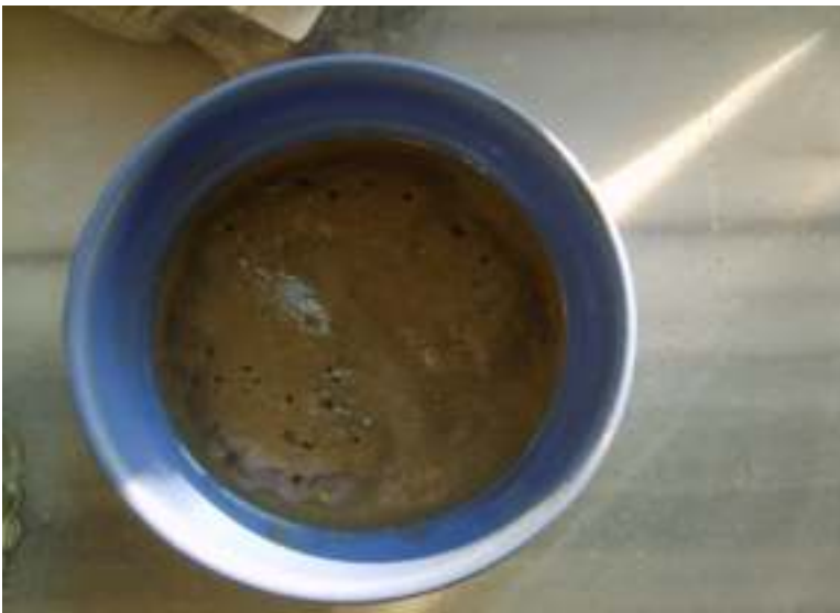
Şekil 5.10. Numunenin Peridrol İle Yakılması
