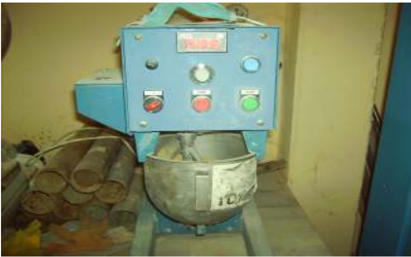
Şekil 5.30. Kum ve Kilin Mikserde Karışımı
