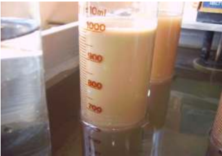
Şekil 5.13. 25°C'de Su Havuzu İçerisine Ölçme Silindirinin Konulması
