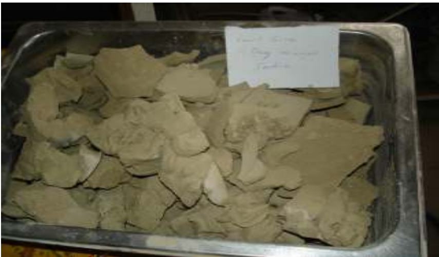
Şekil 5.8. Numunenin Etüvden Çıkarıldıktan Sonraki Şekli
