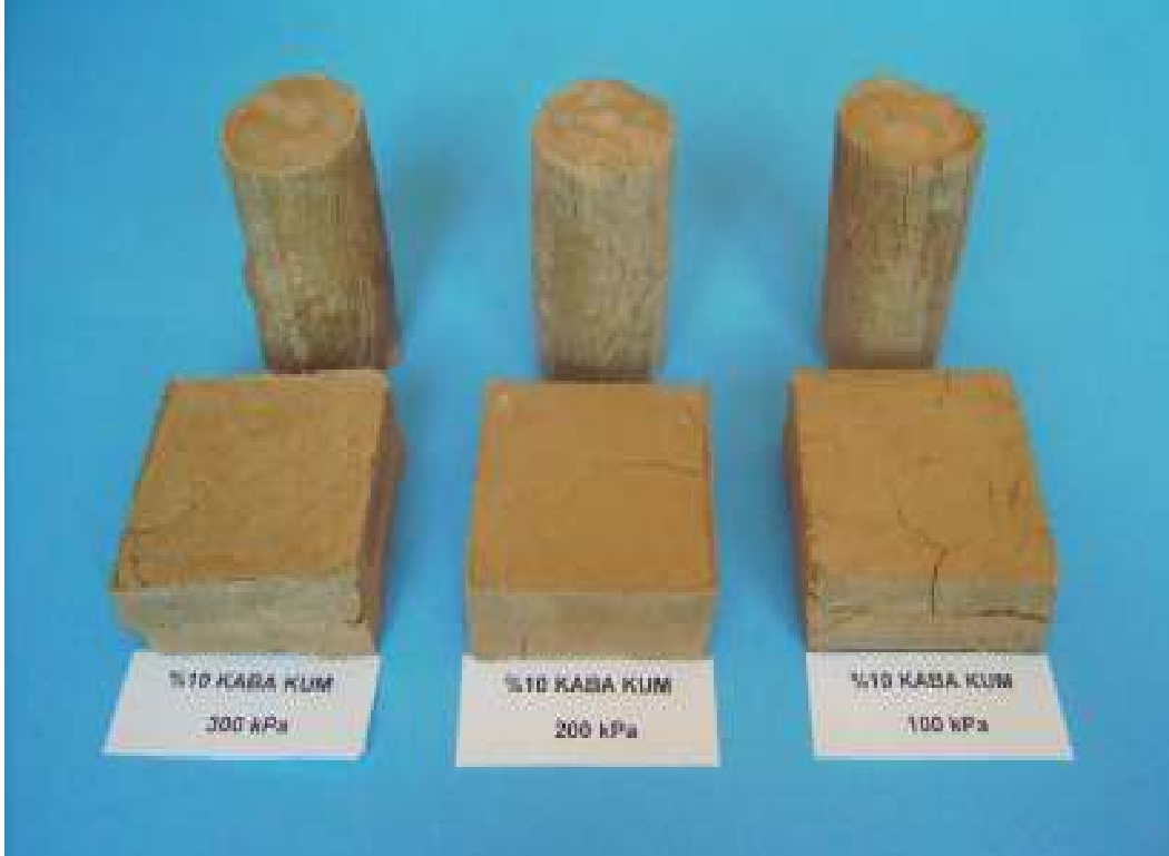
Şekil 5. 117. %10 Kaba Kum İçeren CH Numunesinin 100kPa, 200kPa, 300 kPa Hücre Basıncı ve Normal Gerilme İle Kesildikten Sonraki Numunelerin Görünümü
