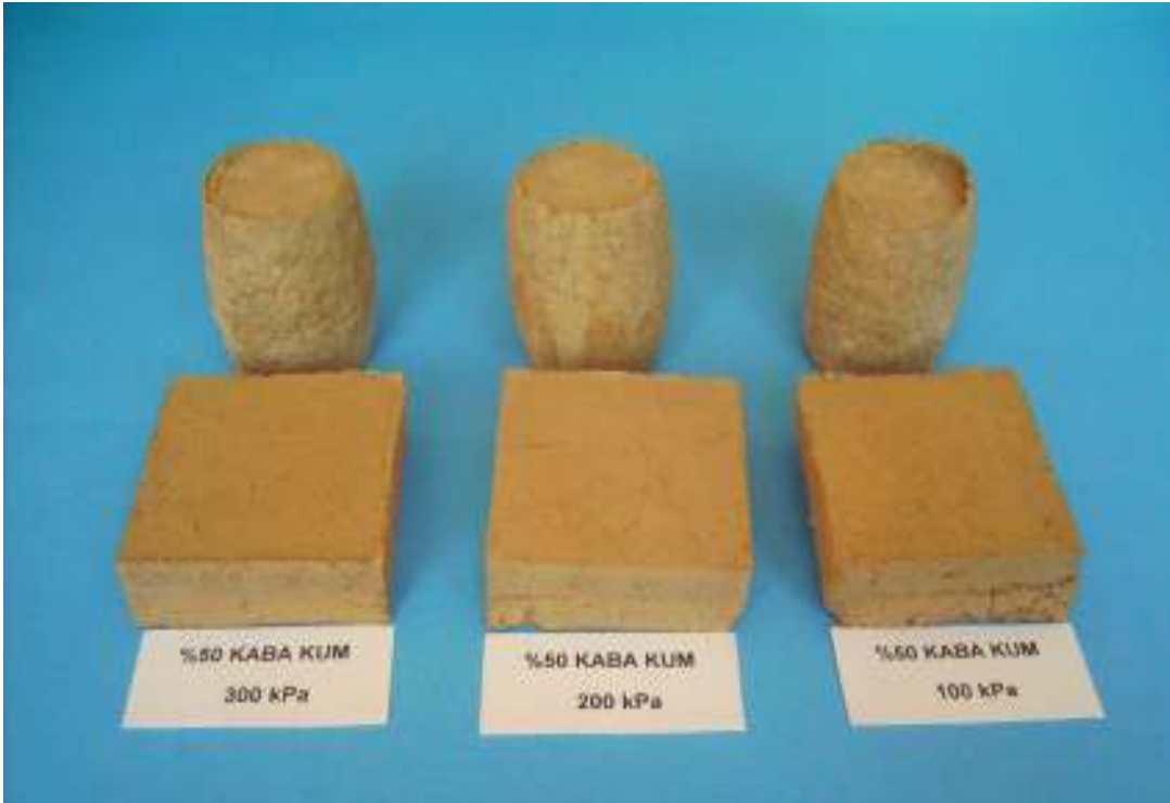
Şekil 5. 123. %50 Kaba Kum İçeren CH Numunesinin 100kPa, 200kPa, 300 kPa Hücre Basıncı ve Normal Gerilme İle Kesildikten Sonraki Numunelerin Görünümü
