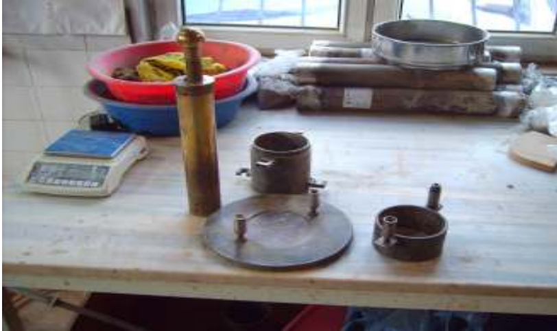
Şekil 5.20. Kompaksiyon Kalıbı ve 2,5 Kilogramlık Tokmak
