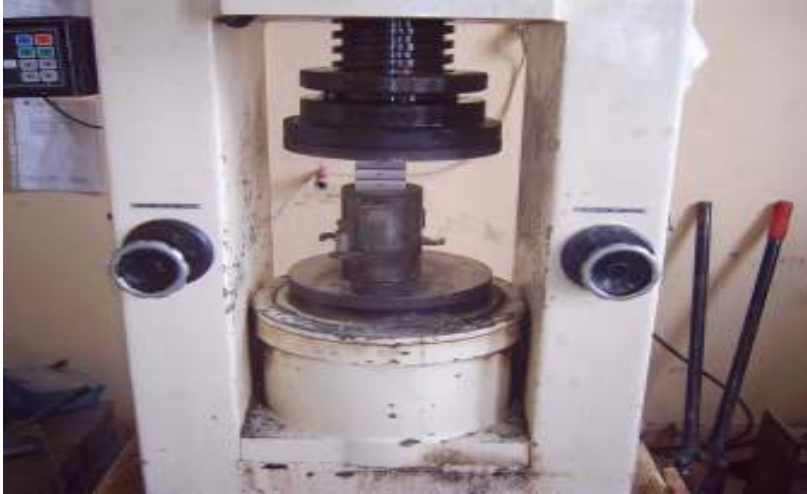
Şekil 5.36. Beton Pres Makinesinde Kesme Kutusu Halkalarının Numune İçerisine İtilmesi
