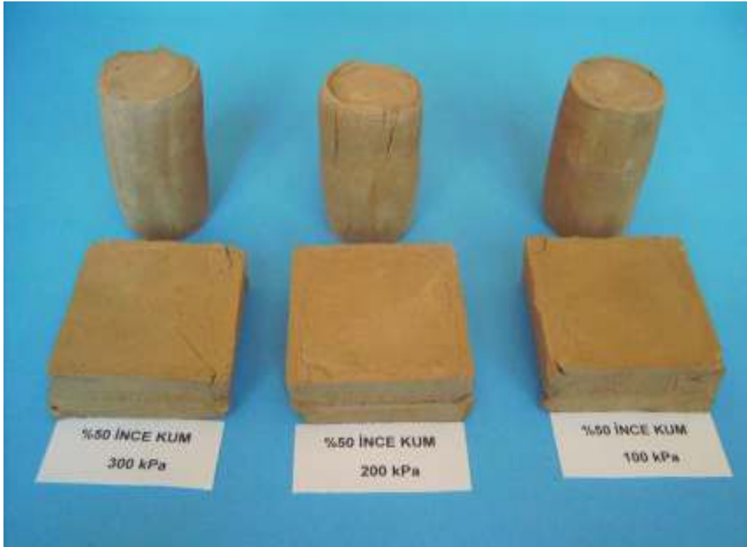
Şekil 5. 121. %50 İnce Kum İçeren CH Numunesinin 100kPa, 200kPa, 300 kPa Hücre Basıncı ve Normal Gerilme İle Kesildikten Sonraki Numunelerin Görünümü
