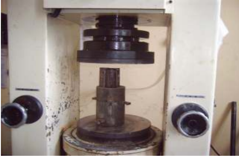
Şekil 5.35. Beton Pres Makinesinde Tüplerin Numune İçerisine İtilmesi
