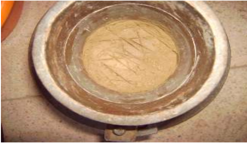
Şekil 5.21. Kompaksiyonla Sıkıştırılmış Numune
