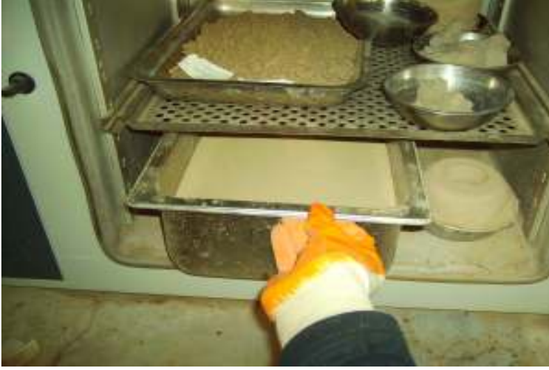
Şekil 5.28. Havadan Aldığı Nemi Kaybetsin Diye Numunenin Etüve Atılması
