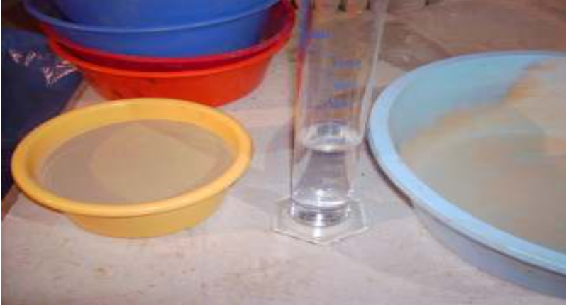
Şekil 5.31. Belirlenen Su Muhtevasında Karışımın Hazırlanması
