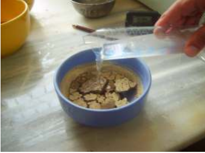
Şekil 5.11. Hidrometre İçin Kullanılacak Numunenin \text{NaPO}_3 İle Dağıtılması
