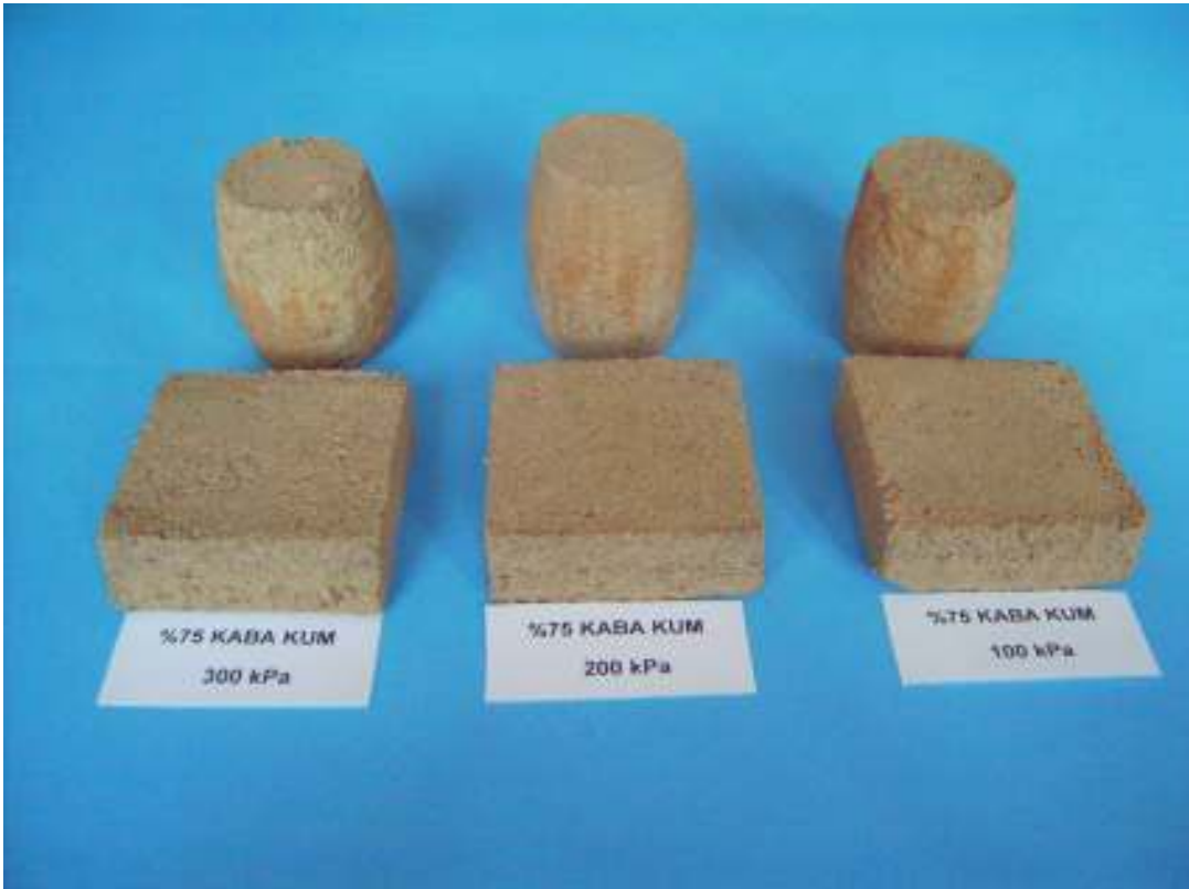
Şekil 5. 126. %75 Kaba Kum İçeren CH Numunesinin 100kPa, 200kPa, 300 kPa Hücre Basıncı ve Normal Gerilme İle Kesildikten Sonraki Numunelerin Görünümü
