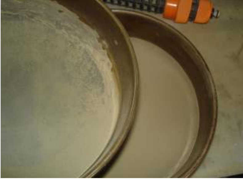
Şekil 5.9. CH Numunesinin Elekten Elenmesi
