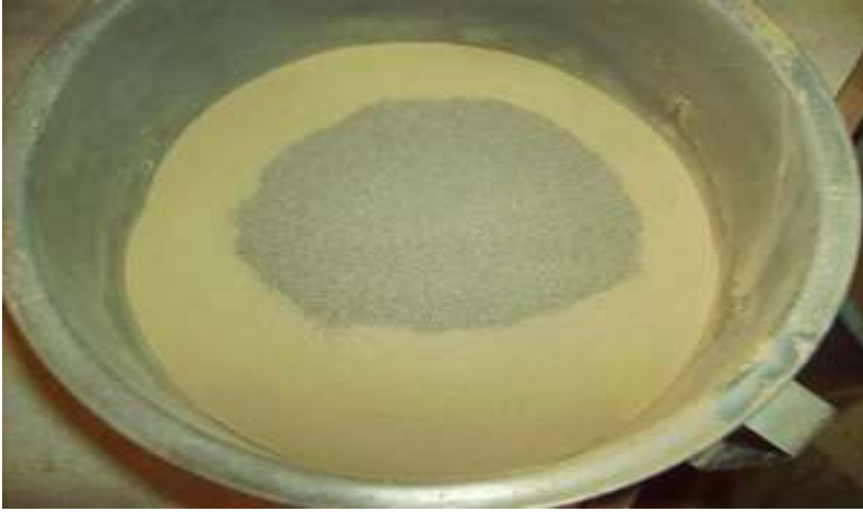
Şekil 5.29. Kum ve Kilin Mikser Kabına Konulması
