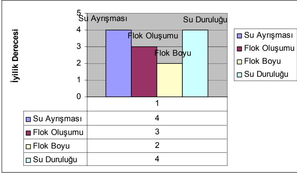
Şekil 3.31. Filtreden Süzülen Zetag 7262 Katyonik Polielektrolitli Biyoçamurunun Su Ayrışması, Flok Oluşumu, Flok Boyu ve Su Duruluğu Dereceleri ( 11/ 03/2007 )
