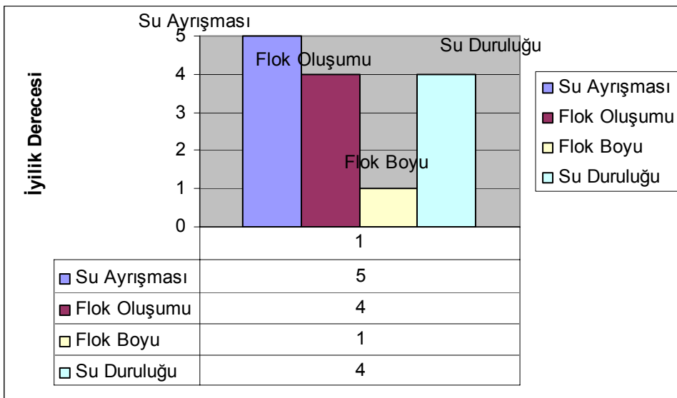
Şekil 3.17. Filtreden Süzülen Zetag 7210I Polielektrolitli Biyoçamurunun Su Ayrışması, Flok Oluşumu, Flok Boyu ve Su Duruluğu Dereceleri ( 10/ 03/2007 )
