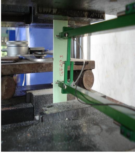
Şekil 4.15 Extansometre ve komparatörün numuneye montajı
