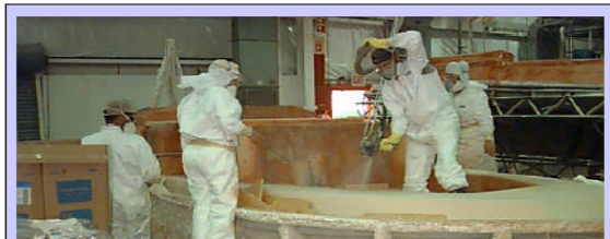
Şekil 3.9 Püskürtme yöntemi uygulama [49]
