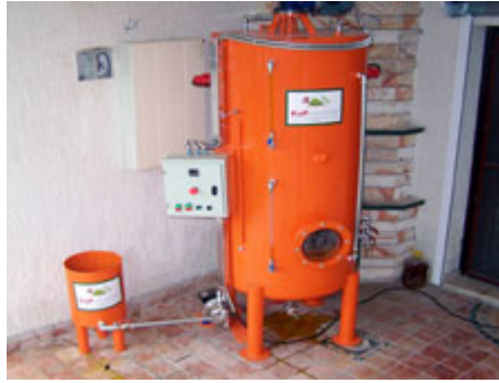
Şekil 2.3. KOP isimli Türk firmasının ev üretimi için biodizel makinası
