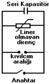
Şekil 3.3. Seri kapasitörlü kompanzasyon ekipmanlarının tipik şeması.
