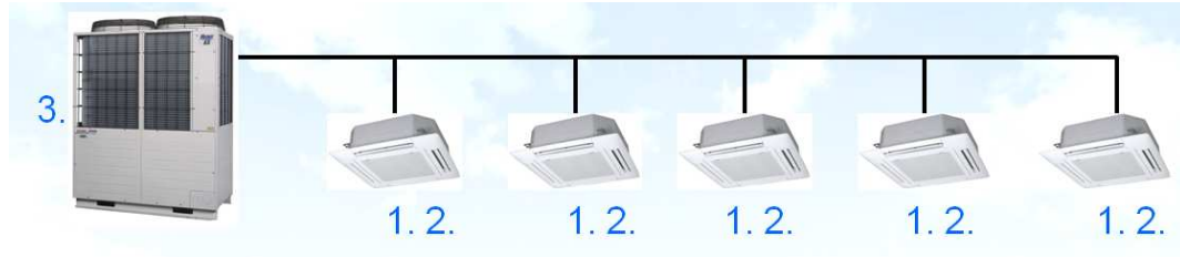
Şekil 5.6 VRV iç ve dış ünite bağlantıları
