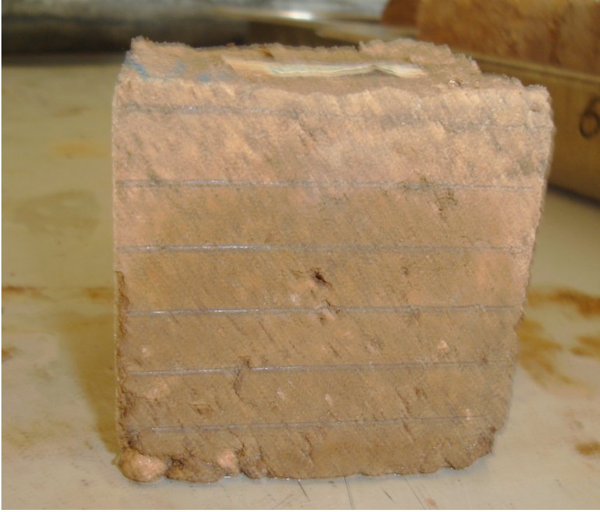
Resim 8.3.27 Toprak+% 50 YFC numunesinde su emme deneyinde 1440 dakika sonra gözlenen suyun yükselme seviyesi
