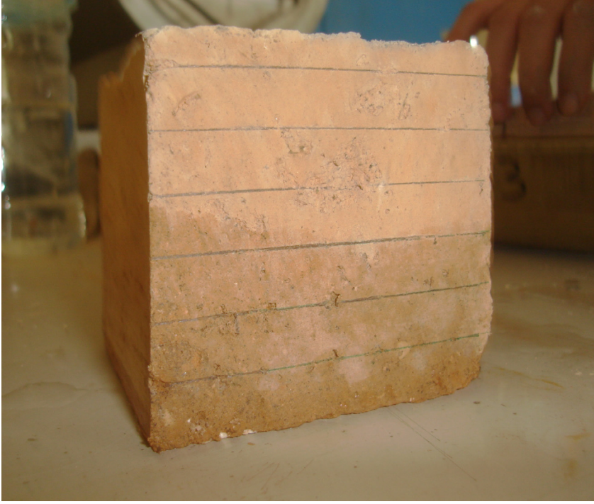
Resim 8.3.3 Alker+% 20YFC numunesinde su emme deneyinde 30 dakika sonra gözlenen suyun yükselme seviyesi
