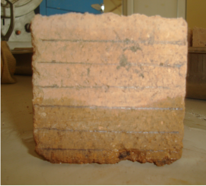
Resim 8.3.7 Toprak+% 20YFC numunesinde su emme deneyinde 30 dakika sonra gözlenen suyun yükselme seviyesi
