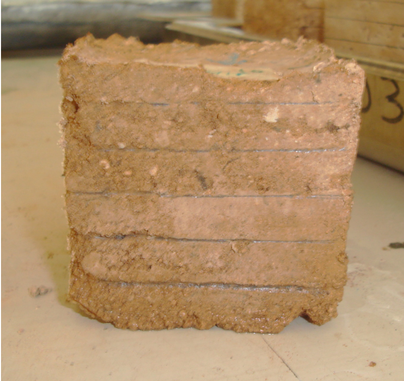
Resim 8.3.19 Alker numunesinde su emme deneyinde 1440 dakika sonra gözlenen suyun yükselme seviyesi
