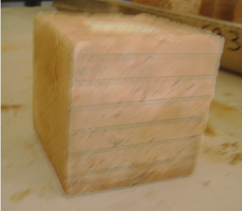
Resim 8.3.22 Alker+% 30 YFC numunesinde su emme deneyinde 1440 dakika sonra gözlenen suyun yükselme seviyesi
