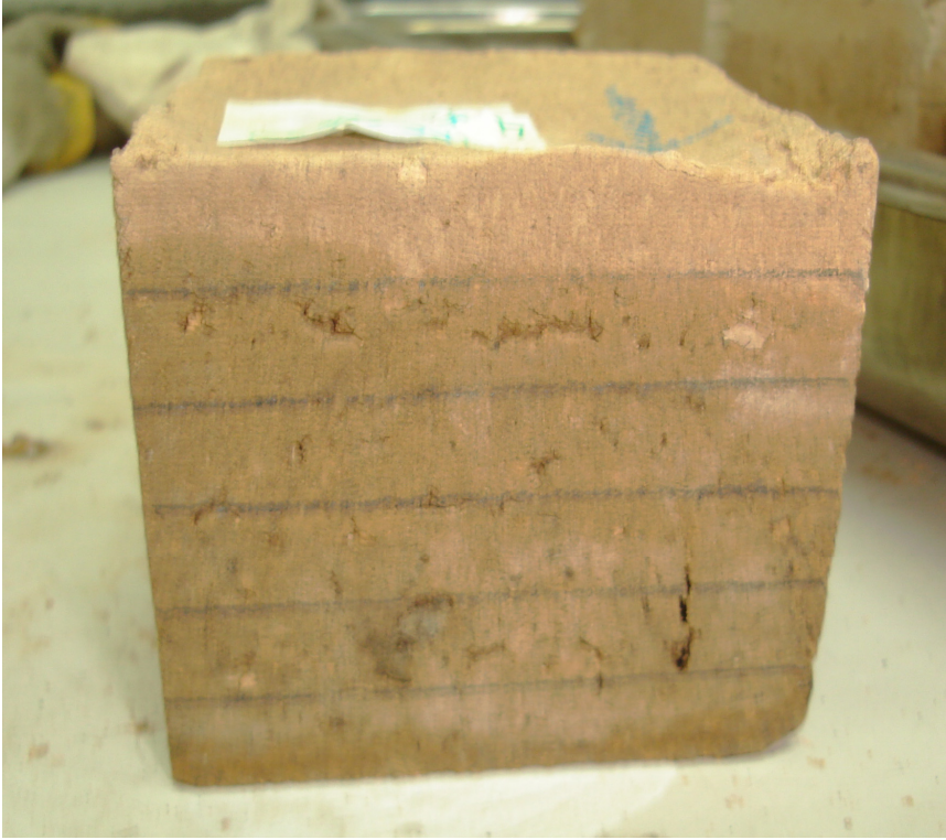
Resim 8.3.17 Toprak+% 30YFC numunesinde su emme deneyinde 90 dakika sonra gözlenen suyun yükselme seviyesi
