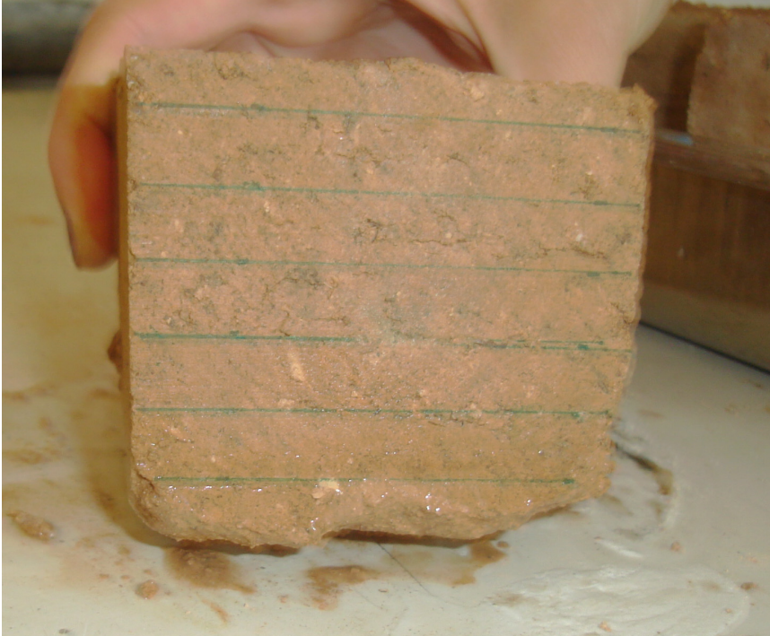
Resim 8.3.24 Toprak+% 10 YFC numunesinde su emme deneyinde 1440 dakika sonra gözlenen suyun yükselme seviyesi
