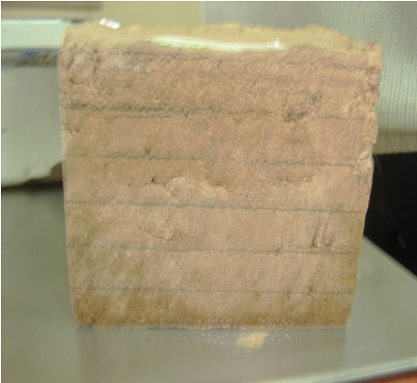
Resim 8.3.14 Alker+% 50YFC numunesinde su emme deneyinde 90 dakika sonra gözlenen suyun yükselme seviyesi
