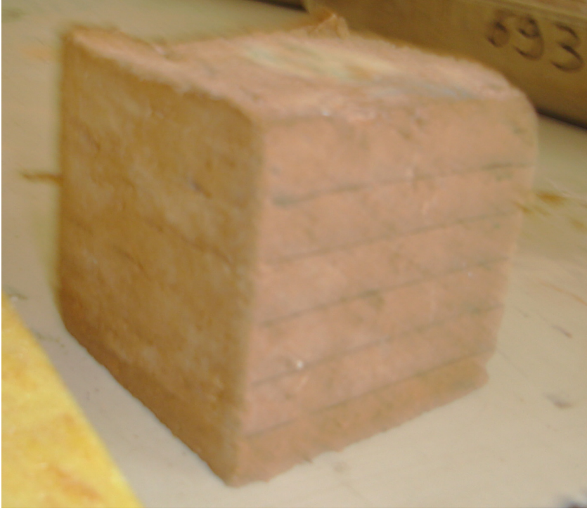
Resim 8.3.21 Alker+% 20 YFC numunesinde su emme deneyinde 1440 dakika sonra gözlenen suyun yükselme seviyesi
