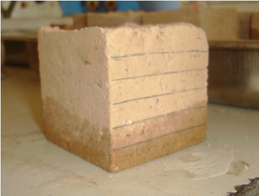
Resim 8.3.2 Alker+% 10YFC numunesinde su emme deneyinde 30 dakika sonra gözlenen suyun yükselme seviyesi
