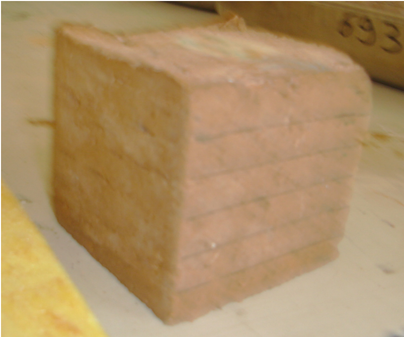
Resim 8.3.20 Alker+% 10 YFC numunesinde su emme deneyinde 1440 dakika sonra gözlenen suyun yükselme seviyesi
