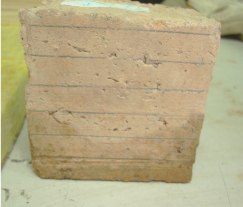
Resim 8.3.12 Alker+% 20YFC numunesinde su emme deneyinde 90 dakika sonra gözlenen suyun yükselme seviyesi
