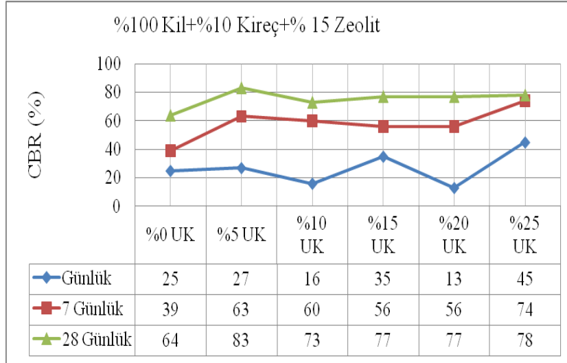
Şekil 6.21. %100 Kıl+%10 Kireç+% 15 Zeolit ve Uçucu Kül İlevli CBR Deneyi Grafiği
