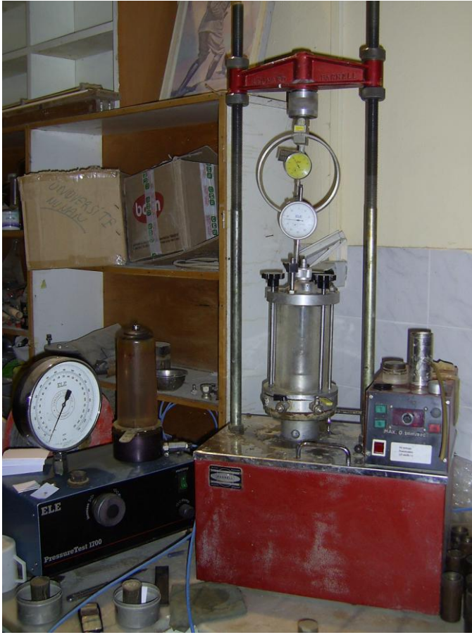
Şekil 5.9. Üç Eksenli Deney Seti
