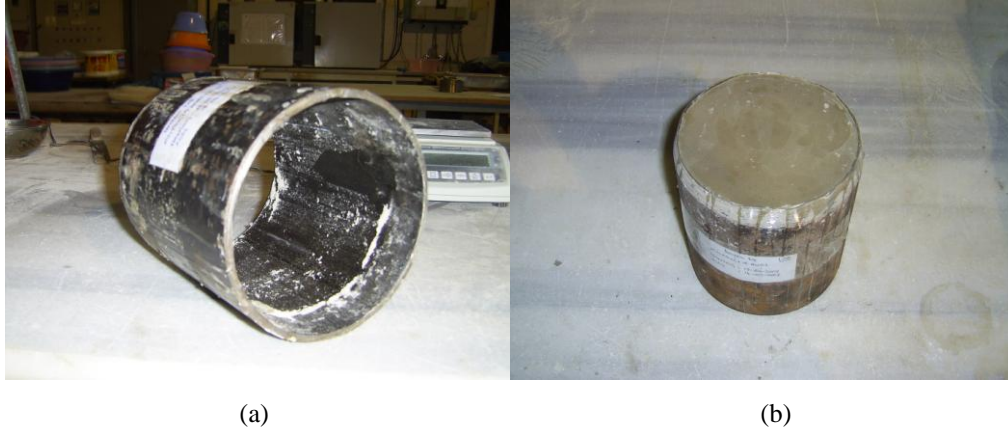
Şekil 5.1. Özel Tüp (a). İçi Boş Hali (b). Alt ve Üst Tarafını Mumlanmış Hali
