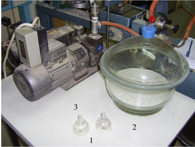
Şekil 5.2. Özgül Ağırlık Deney Seti 1. Piknometre 2. Desikatör 3. Vakum Pompası
