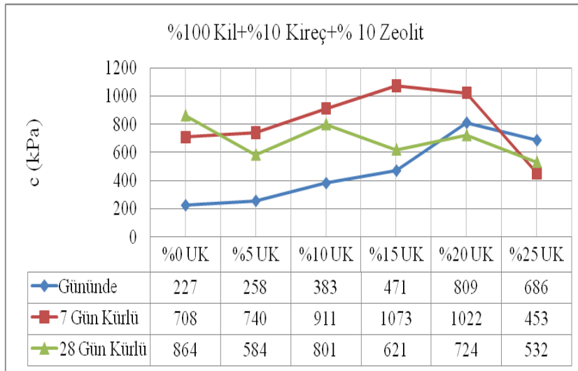
Şekil 6.14. %100 Kil+%10 Kireç+% 10 Zeolit ve Uçucu Kül İlaveli 3 Eksenli Hücre Basma Deneyi Grafiği
