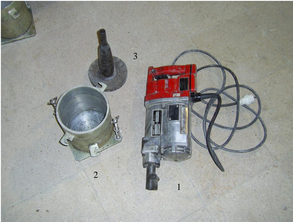
Şekil 5.8. Titreşimli Kompaksiyon Deney Seti 1. Hitli 2. Kompaksiyon Kalıbı 3. Titreşimli Tokmak
