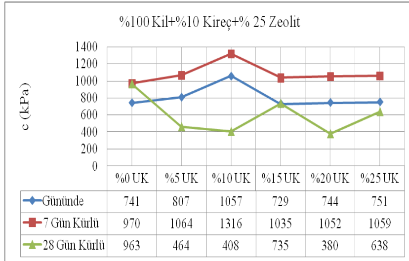
Şekil 6.17. %100 Kil+%10 Kireç+% 20 Zeolit ve Uçucu Kül İlaveli 3 Eksenli Hücre Basma Deneyi Grafiği
